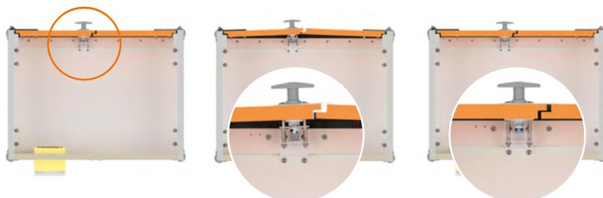
Il meccanismo lockEX, protetto da brevetto, riduce l'energia dell'esplosione in modo controllato grazie a una piccola fessura.
