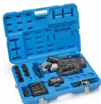
Il Kit comprende l'utensile oleodinamico a batteria **B1300-C** (132 kN) completo di 7 coppie matrici (da 50 a 240 mm<sup>2</sup>) e di una pratica e robusta valigetta per il trasporto dell'utensile e dei suoi accessori.
