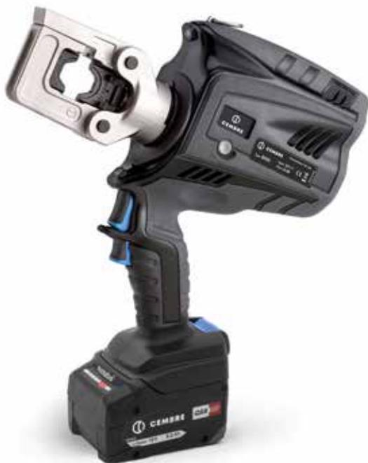
**B500** è adatto all'installazione di connettori elettrici a compressione su conduttori in genere fino a 300 mm<sup>2</sup>. L'utensile utilizza la serie di matrici comuni agli utensili e alle teste da 50 kN di produzione CEMBRE.
