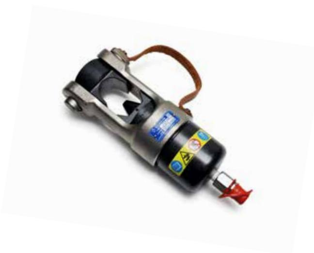
Testa oleodinamica completa di innesto rapido maschio con bloccaggio automatico. Può impiegare, mediante l'adattatore tipo **AU230-130D**, la serie di matrici ad innesto semicircolare comune agli utensili sviluppanti una forza di 130 kN. È disponibile inoltre, una serie di matrici per comprimere connettori elettrici conformi alle norme DIN ed una matrice da taglio per corde in rame, alluminio, aldrej, alluminio-acciaio e acciaio.
