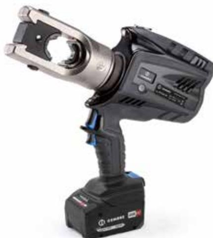
**B1350-UC** è adatto alla installazione di connettori elettrici a compressione sia su cavi in alluminio mediante la tecnica della punzonatura profonda in matrice chiusa, che su conduttori in genere fino a 400 mm<sup>2</sup>.
