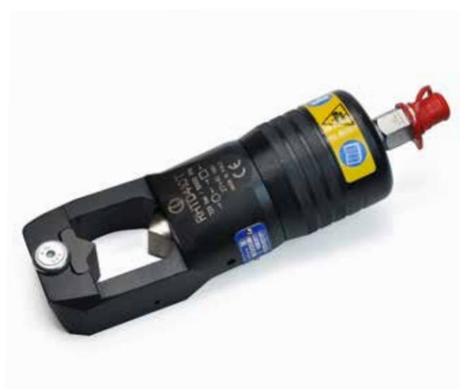
Testa oleodinamica trancia dadi per il taglio di dadi aventi la dimensione dell'esagono da 27 mm a 41 mm; è munita di innesto rapido per il collegamento ad una pompa avente pressione di esercizio 700 bar.
