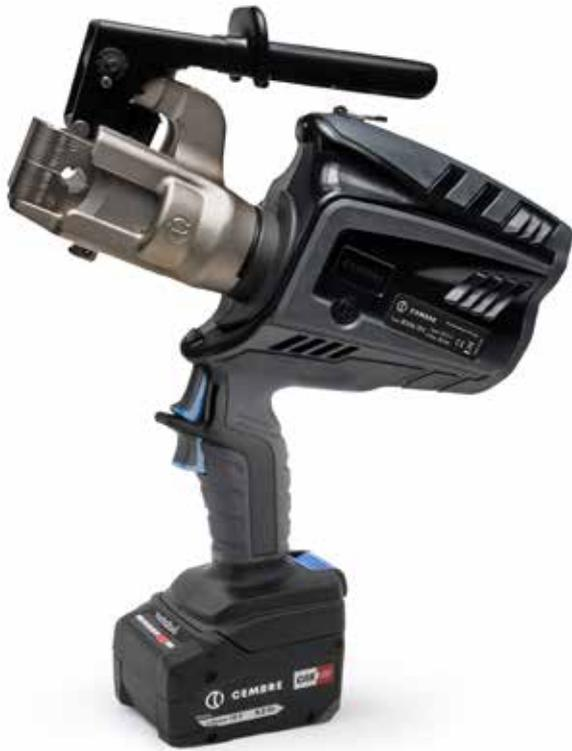
Adatto al taglio di fili di contatto in rame profilati, **B500-TFC** è un utensile a batteria azionabile facilmente con una mano. L'utensile in accoppiamento con le matrici della serie **MFC**, assicura un taglio del filo perfettamente perpendicolare e senza deformazione della sagoma, permettendo una corretta ed agevole installazione di giunti a piena trazione.
