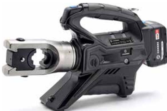
**B1300-UC** è adatto alla installazione di connettori elettrici a compressione sia su cavi in alluminio mediante la tecnica della punzonatura profonda in matrice chiusa, che su conduttori in genere fino a 400 mm<sup>2</sup>.
