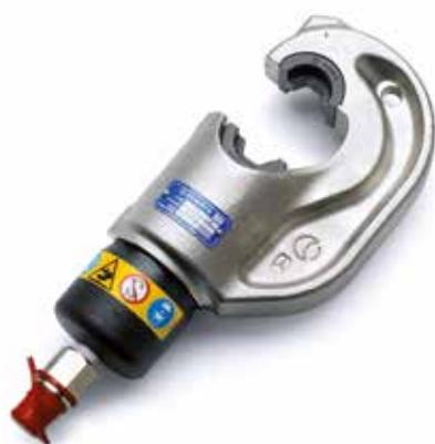
Testa oleodinamica caratterizzata da una apertura della "C" maggiorata (42 mm); completa di innesto rapido maschio con bloccaggio automatico, avente gli stessi campi d'utilizzo dell'utensile **HT131LN-C**.
