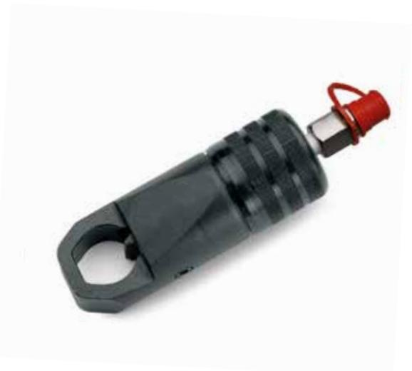
Testa oleodinamica trancia dadi per il taglio di dadi aventi la dimensione dell'esagono da 16 mm a 27 mm; è munita di innesto rapido per il collegamento ad una pompa avente pressione di esercizio 700 bar.
