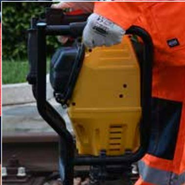
**Rollbar per la protezione del motore in caso di cadute accidentali**
