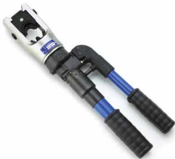
Ancora più compatto, robusto e maneggevole, consente, con adeguati accessori, la realizzazione di connessioni elettriche su cavi in alluminio mediante la tecnica della punzonatura profonda in matrice chiusa.
