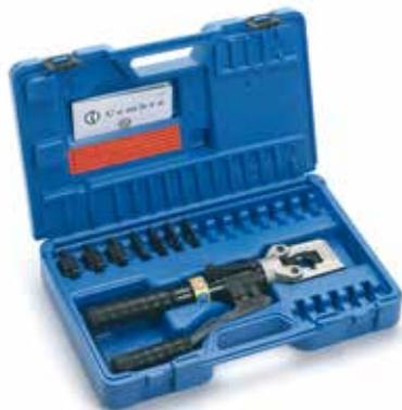
Il Kit comprende l'utensile oleodinamico **HT51** (50 kN) completo di 8 coppie matrici (da 25 a 185 mm<sup>2</sup>) e di una pratica e robusta valigetta per il trasporto.
