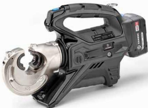
**B1300-C** è adatto all'installazione di connettori elettrici a compressione su conduttori in genere fino a 400 mm<sup>2</sup> e particolarmente adatto per l'esecuzione di impianti IS e TE. L'utensile utilizza la serie di matrici comune agli utensili e alle teste da 130 kN di produzione CEMBRE.
