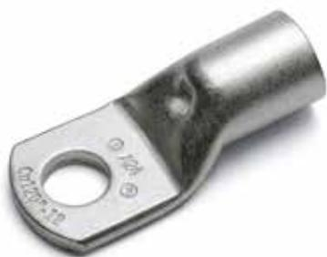
I capicorda della serie A-M sono ricavati da tubo di rame elettrolitico con purezza superiore al 99,9% e di sezione tale da garantire sia una buona connessione elettrica che un'adeguata resistenza alla trazione.
