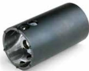
Mandrino opzionale caratterizzato da innesto rapido e bloccaggio automatico delle punte di foratura. Intercambiabile col mandrino standard **MND**, è adatto a ricevere le punte a DIS. FS 7874, con codolo di attacco Ø16 mm e lunghezza 325 mm secondo: CAT. 744 / PROG. 490 - 491 - 492 - 493
