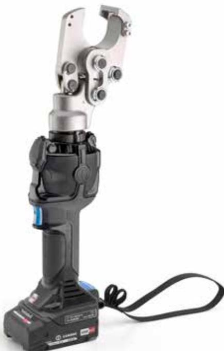
**B-TC320ND** è adatto ad effettuare il taglio di conduttori e funi in rame, alluminio, aldreyl, acciaio e alluminio-acciaio. Le lame sono realizzate in acciaio speciale ad elevata resistenza ed opportunamente trattato. Maggiore velocità di taglio e forza sviluppata grazie al nuovo sistema oleodinamico a due velocità idrauliche. Provvisto di valvola di massima pressione. Temperatura di funzionamento: da -15 a +50 °C.
