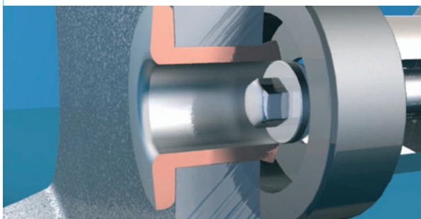
Sezione trasversale della bussola in rame prima e dopo il processo di pressatura
