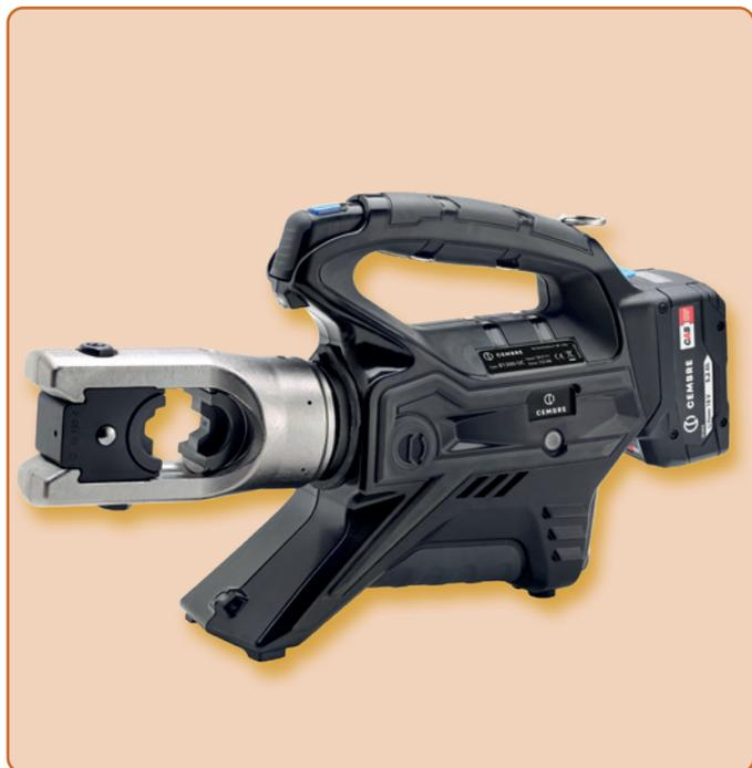
Il utensile di pressatura idraulica a batteria **B1300-UC** presenta un dispositivo idraulico a due pistoni. La testa di pressatura è girevole di 180°, pertanto l'applicazione è possibile anche in luoghi stretti. Un chip controlla la modalità di lavoro e spegne automaticamente il motore non appena è realizzata la pressatura. Questo consente di risparmiare energia e di aumentare la durata della batteria. Testa di pressatura idonee a pagina 140.
