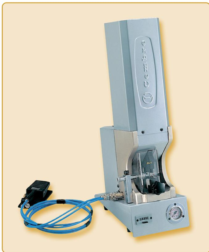
Pressa da tavolo pneumatica con controllo manuale e grande versatilità d'uso. Grazie a un'ampia scelta di matrici intercambiabili, sono adatti per capicorda isolati e non isolati, capicorda trasversali, connettori piatti e capicorda tubolari da 0.2 - 50mm<sup>2</sup>. Il **PNB-1** è inoltre caratterizzato da dimensioni e peso ridotti.
