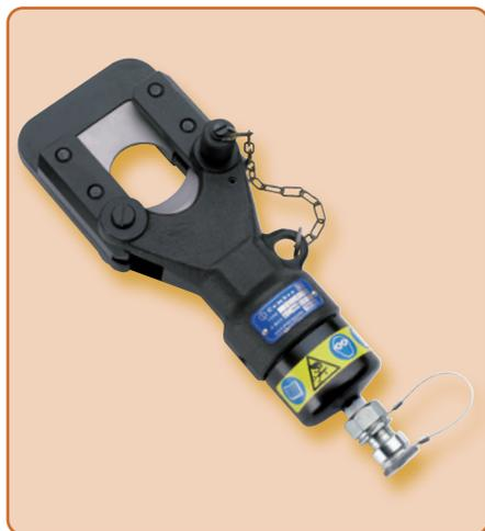
La testa di taglio idraulica **TC04N** serve per tagliare materiali grandi e molto duri con un diametro fino a 45 mm. Le lame di taglio sono rifinite in particolare metallo di alta qualità. Il utensile è dotato di un raccordo ad attacco rapido senza fuoriuscite d'olio che consente il collegamento ad una pompa idraulica con una pressione di esercizio massima di 700 bar (vedere le pompe idrauliche a pagina 131).
