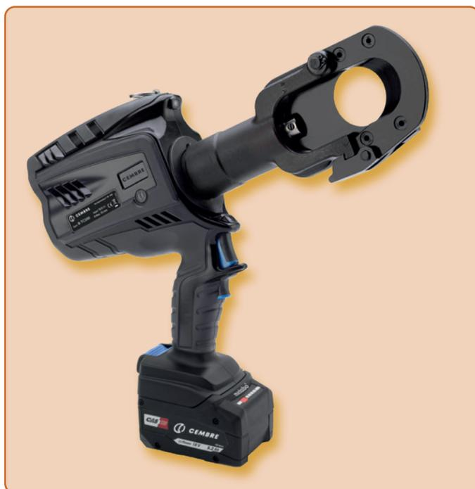
La taglierina idraulica a batteria **B-TC500** con unità idraulica a doppio pistone serve per tagliare cavi telefonici, in rame e alluminio con un diametro fino a 50 mm (ad es. 4 x 150 mm<sup>2</sup> NYY-0). Grazie alla particolare affilatura e alla geometria speciale della lama di taglio è possibile garantire un taglio diritto. Grazie alla chiusura sulla testa il utensile può essere utilizzato per tagliare tanto materiale. Il buon maneggiamento è garantito grazie alla testa girevole di 90°.
