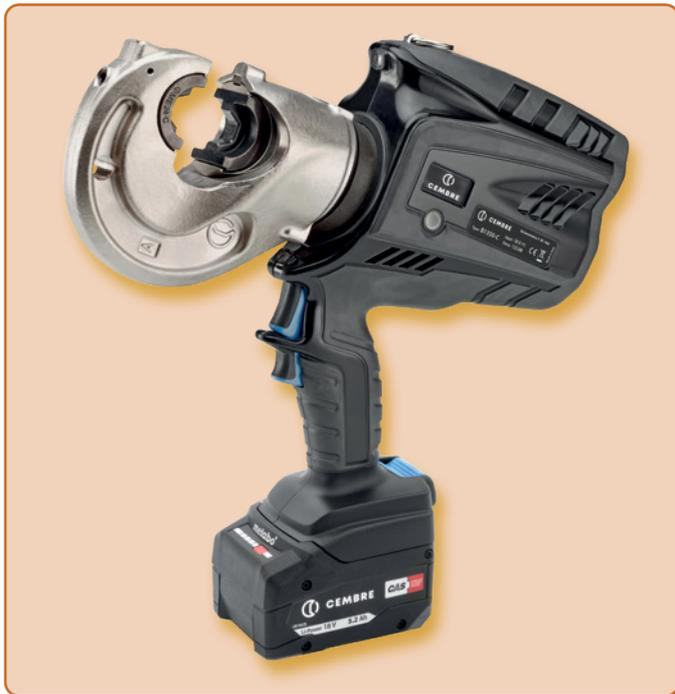
Il utensile di pressatura idraulica a batteria **B1350-C** presenta un dispositivo idraulico a due pistoni. La testa di pressatura è girevole di 180°, pertanto l'applicazione è possibile anche in luoghi stretti. Testa di pressatura idonee a pagina 140.
