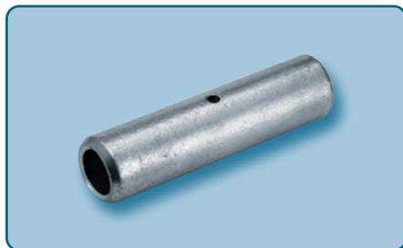
I connettori di pressatura di tipo DSV sono realizzati in rame elettrolitico. I connettori di pressatura sono ricotti e zincati. Le estremità sono collegate per poter portare facilmente il cavo. Presentano le stesse dimensioni dei tubi utilizzati per il capicorda DR. Sono dotati di una battuta centrale per garantire una posizione corretta del cavo.
