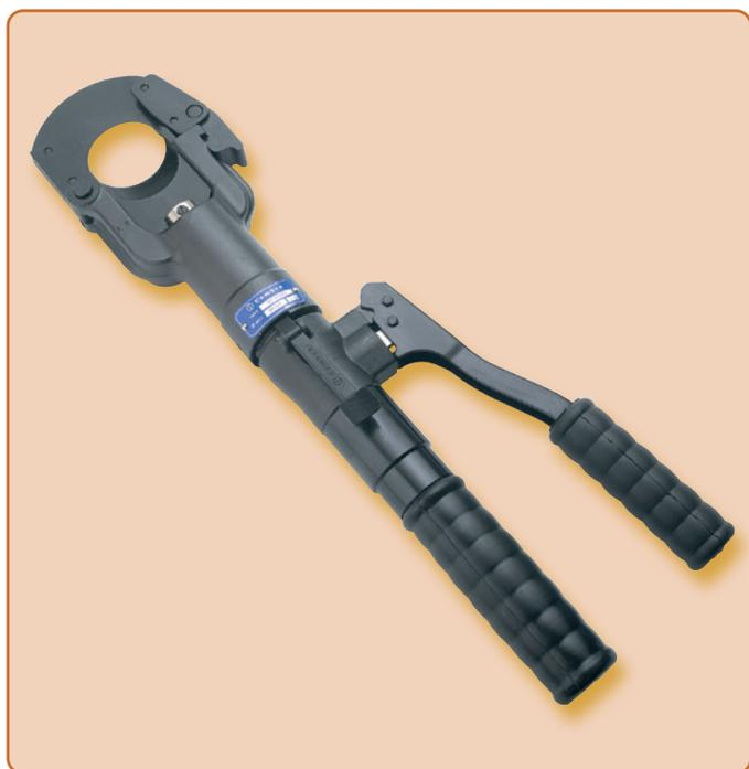
La taglierina per cavi manuale idraulica **HT-TC051** serve per tagliare cavi con diametro massimo fino a 50 mm (ad es. 4 x 150 mm<sup>2</sup> NYY-0). Grazie alla particolare affilatura e alla geometria speciale della lama di taglio è possibile garantire un taglio dritto. La testa girevole di 90° e la pratica chiusura consentono un facile maneggiamento.
