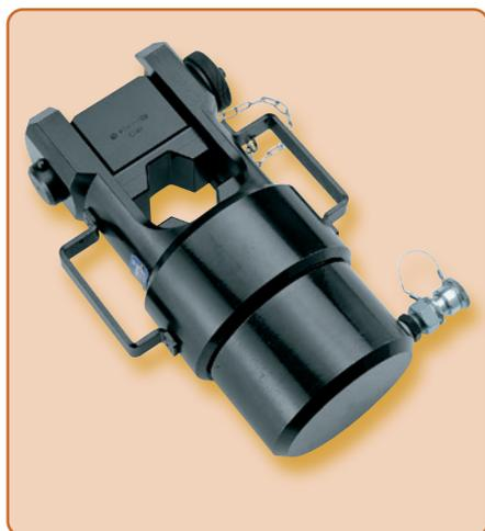
La testa di pressatura idraulica **RHU520** è dotata di un raccordo ad attacco rapido senza fuoriuscite d'olio che consente il collegamento ad una pompa idraulica con una pressione di esercizio massima di 700 bar (vedere le pompe idrauliche a pagina 131). Con l'adattatore (tipo **AU 520-130C**) è possibile usare le teste di pressatura dell' utensile 130-kN di Cembre anche con il **RHU520**.
