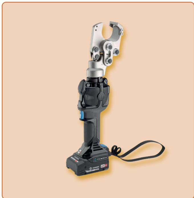
La taglierina idraulica a batteria **B-TC320NDF** con unità idraulica a due pistoni serve in particolare per tagliare di cavi in rame e in alluminio. Per le sue caratteristiche costruttive si presta anche al taglio di cavi telefonici, con un diametro fino a 32 mm. Azionabile in tutte le fasi di utilizzo con una sola mano, grazie all'equilibratura delle masse, risulta estremamente versatile e maneggevole. La testa può ruotare di 180° per facilitare il funzionamento negli spazi limitati.
