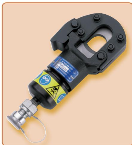
La testa di taglio idraulica **TC025** serve per tagliare materiali grandi e molto duri con un diametro fino a 25 mm. Le lame di taglio sono rifinite in particolare metallo di alta qualità. Il utensile è dotato di un raccordo ad attacco rapido senza fuoriuscite d'olio che consente il collegamento ad una pompa idraulica con una pressione di esercizio massima di 700 bar (vedere le pompe idrauliche a pagina 131).
