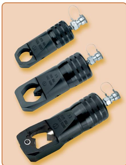
Gli utensili servono per svitare dadi a testa quadrata e esagonali e spine di fissaggio (vedere tabella). Lavori lunghi e durante i quali si sviluppano scintille come molatura o tagli. Gli apriadi idraulici sono dotati di un raccordo ad attacco rapido senza fuoriuscite d'olio che consente il collegamento ad una pompa idraulica con una pressione di esercizio massima di 700 bar (vedere le pompe idrauliche a pagina 131).
