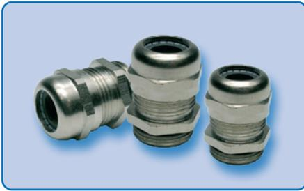
Materiale: ottone nichelato per cavo con schermatura, con scarico della trazione interno secondo EN 50262 versione A, applicazioni con lamelle in PA6.6
