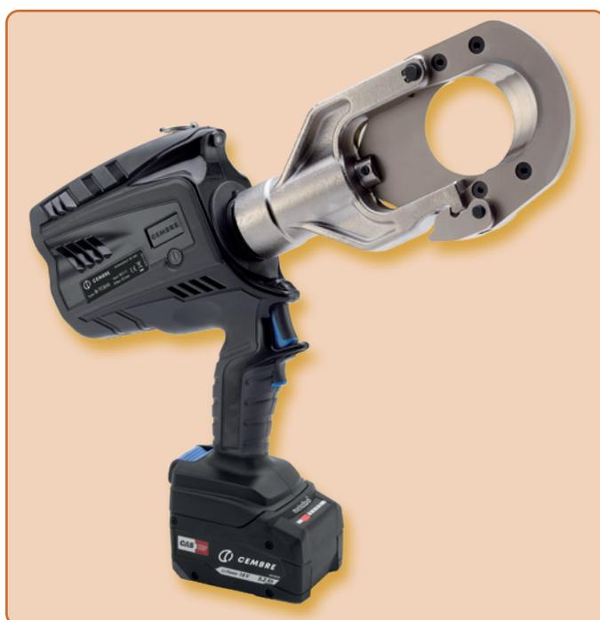
La taglierina idraulica a batteria **B-TC650** con unità idraulica a doppio pistone serve per tagliare cavi telefonici, in rame e alluminio con un diametro fino a 65 mm. Grazie alla chiusura sulla testa il utensile può essere utilizzato per tagliare tanto materiale. Il buon maneggiamento è garantito grazie alla testa girevole di 335°.
