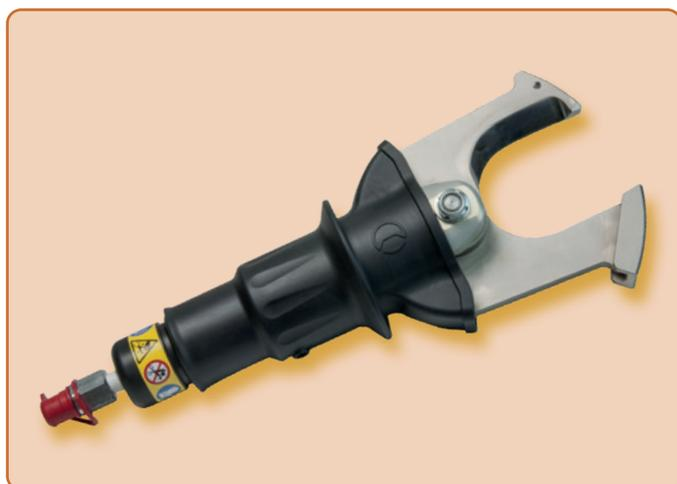
La testa di taglio idraulica **TC065-SC** serve per tagliare cavi telefonici, in rame e alluminio con un diametro fino a 65 mm. Le lame di taglio sono rifinite con acciaio di elevata qualità e sottoposte a trattamento termico per garantire una lunga durata. Il utensile è dotato di un raccordo ad attacco rapido senza fuoriuscite d'olio che consente il collegamento ad una pompa idraulica con una pressione di esercizio massima di 700 bar (vedere le pompe idrauliche a pagina 131).
