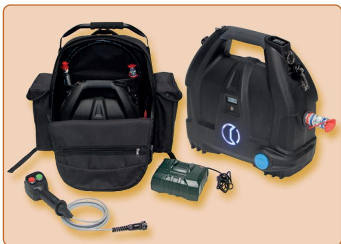
La pompa idraulica a batteria **B70M-P36** presenta una batteria 36V - 6.2 Ah e funziona con una pressione di lavoro di 700 bar. La pompa può essere azionata con telecomando o pedale. Con una ricarica della batteria è possibile eseguire ad esempio fino a 90 tagli NAE-KEBY 3 x 150 mm<sup>2</sup>.
