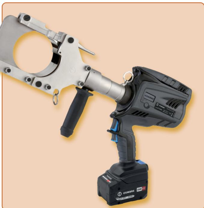
La taglierina idraulica a batteria **B-TC950** con unità idraulica a doppio pistone serve per tagliare cavi in rame e alluminio con un diametro fino a 95 mm. Grazie alla chiusura sulla testa il utensile può essere utilizzato per tagliare tanto materiale. Il buon maneggiamento è garantito grazie alla testa girevole di 335°.
