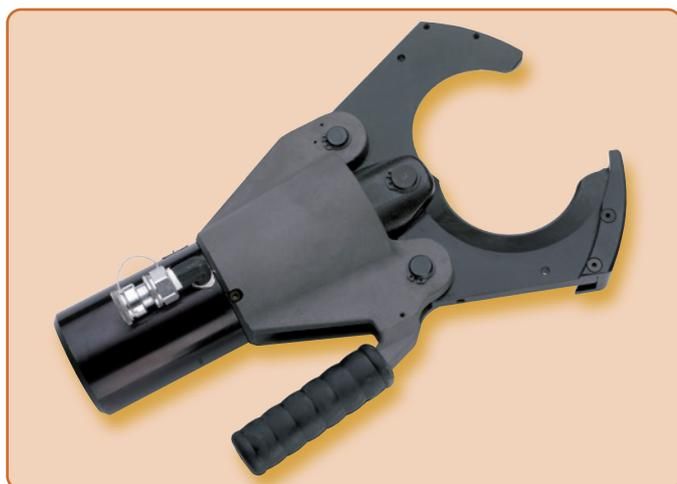
La testa di taglio idraulica **TC096** serve per tagliare cavi con un diametro massimo fino a 95 mm. Con questo modello di testa di taglio aperta una guida della lama evita il blocco e la piegatura dei materiali da tagliare. Il utensile è dotato di un raccordo ad attacco rapido senza fuoriuscite d'olio che consente il collegamento ad una pompa idraulica con una pressione di esercizio massima di 700 bar (vedere le pompe idrauliche a pagina 131).
