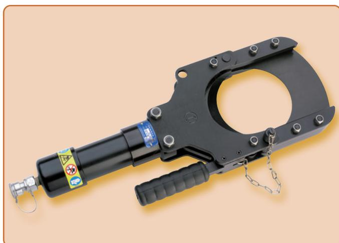
La testa di taglio idraulica **TC120** serve per tagliare cavi con un diametro massimo fino a 120 mm. La pratica chiusura consente un utilizzo facilissimo. Grazie alla particolare affilatura e alla geometria speciale della lama è possibile garantire un taglio diritto. Il utensile è dotato di un raccordo ad attacco rapido senza fuoriuscite d'olio che consente il collegamento ad una pompa idraulica con una pressione di esercizio massima di 700 bar (vedere le pompe idrauliche a pagina 131).
