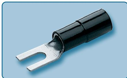
I terminali di tipo ANE-U sono realizzati da nastro di rame, saldati e precotti. Il supporto di ingresso in nylon consente un'introduzione semplice e pulita dei cavetti.
