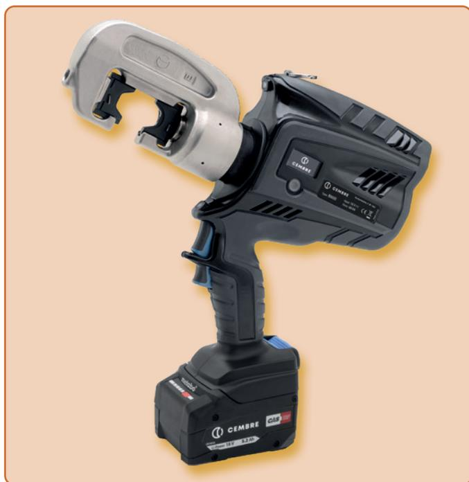
Il utensile di pressatura idraulica a batteria **B600** presenta un dispositivo idraulico a due pistoni. La testa di pressatura è girevole di 180°, pertanto l'applicazione è possibile anche in luoghi stretti. È possibile utilizzare tutte le teste di pressatura secondo DIN 48083, in particolare quelle degli utensili 68 kN (molla di apertura necessaria). È anche possibile utilizzare teste di pressatura a presa della misura 1 di altri produttori. Testa di pressatura idonee a pagina 140.
