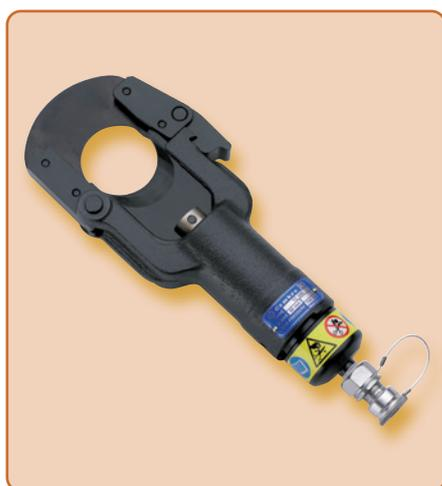
La testa di taglio idraulica **TC050** serve per tagliare cavi con diametro massimo fino a 50 mm (ad es. 4 x 150 mm<sup>2</sup> NYY-0). Grazie alla particolare affilatura e alla geometria speciale della lama di taglio è possibile garantire un taglio dritto. Il utensile è dotato di un raccordo ad attacco rapido senza fuoriuscite d'olio che consente il collegamento ad una pompa idraulica con una pressione di esercizio massima di 700 bar (vedere le pompe idrauliche a pagina 131).
