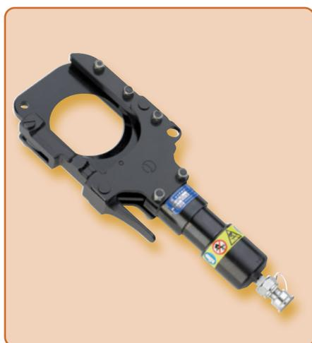
La testa di taglio idraulica **TC085** serve per tagliare cavi con diametro massimo fino a 85 mm (ad es. 4 x 240 mm<sup>2</sup> NYY-0). Grazie alla particolare affilatura e alla geometria speciale della lama di taglio è possibile garantire un taglio dritto. Il utensile è dotato di un raccordo ad attacco rapido senza fuoriuscite d'olio che consente il collegamento ad una pompa idraulica con una pressione di esercizio massima di 700 bar (vedere le pompe idrauliche a pagina 131).
