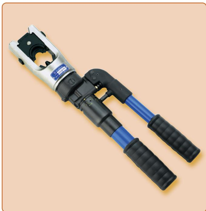
L'**HT131-UC** è una pressa manuale idraulica con unità idraulica con due pistoni che garantisce lavori rapidi. La testa girevole di 180° consente un facile maneggiamento. Il sistema di fuoriuscita di pressione integrato può essere azionato facilmente in qualsiasi momento. È disponibile una vasta gamma di teste di pressatura (a pagina 140).
