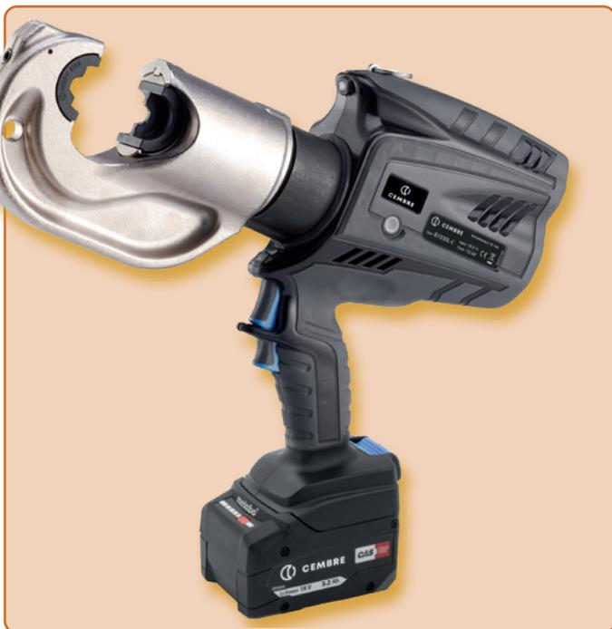
Il utensile di pressatura idraulica a batteria **B1350L-C** presenta un dispositivo idraulico a due pistoni. La testa di pressatura è girevole di 180°, pertanto l'applicazione è possibile anche in luoghi stretti. L'ampiezza di apertura della testa è 42 mm ed è particolarmente adatta alla pressatura di tagli trasversali più grandi. Testa di pressatura idonee a pagina 140.
