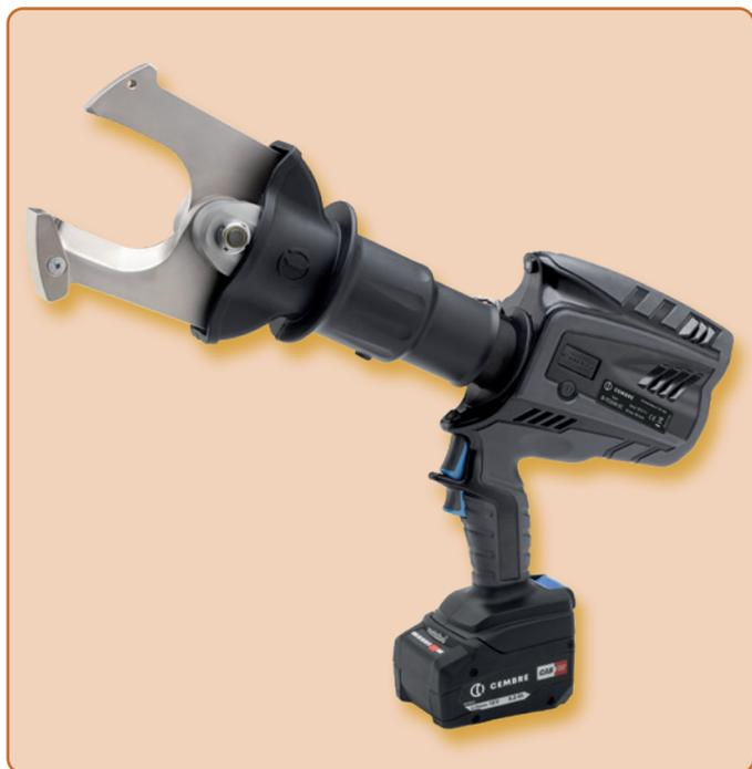
La taglierina idraulica a batteria **B-TC650-SC** con unità idraulica a doppio pistone serve per tagliare cavi telefonici, in rame e alluminio con un diametro fino a 65 mm. Le lame di taglio sono rifinite con acciaio di elevata qualità e sottoposte a trattamento termico per garantire una lunga durata. Con questo modello di testa di taglio aperta una guida della lama evita il blocco e la piegatura dei materiali da tagliare. Il buon maneggiamento è garantito grazie alla testa girevole di 335°.
