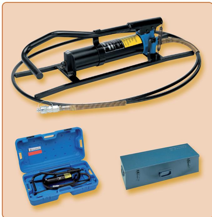
Pompe idrauliche a pedale con due pistoni **PO7000** con una pressione di esercizio massima di 700 bar. La pompa è fornita completa di tubo flessibile ad alta pressione di 3 m e un raccordo ad attacco rapido senza fuoriuscite d'olio 3/8" NPT. La fuoriuscita di pressione avviene tramite il pedale semplice da usare applicato sul retro della pompa.
