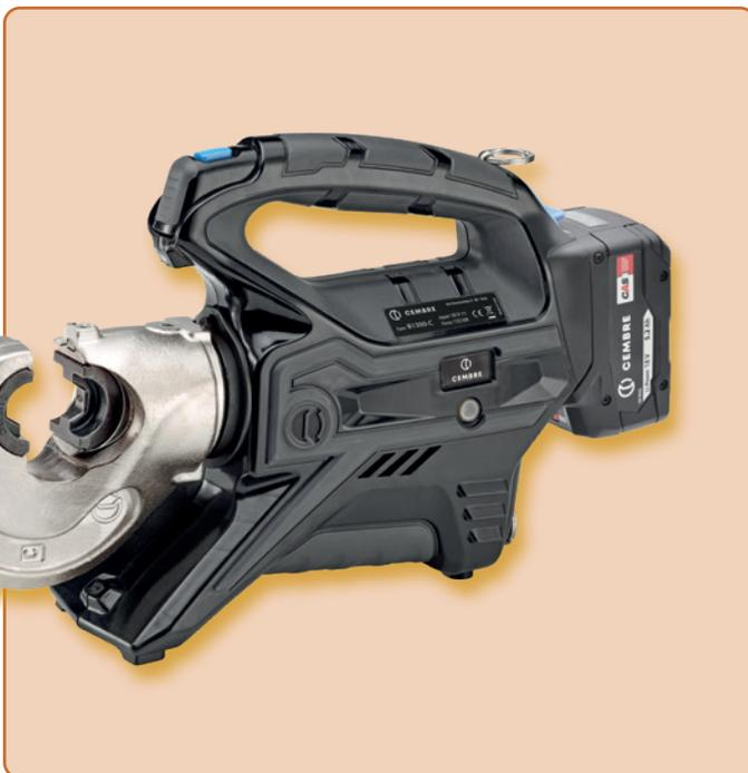
Il utensile di pressatura idraulica a batteria **B1300-C** presenta un dispositivo idraulico a due pistoni. La testa di pressatura è girevole di 180°, pertanto l'applicazione è possibile anche in luoghi stretti. Un chip controlla la modalità di lavoro e spegne automaticamente il motore non appena è realizzata la pressatura. Questo consente di risparmiare energia e di aumentare la durata della batteria. Testa di pressatura idonee a pagina 140.
