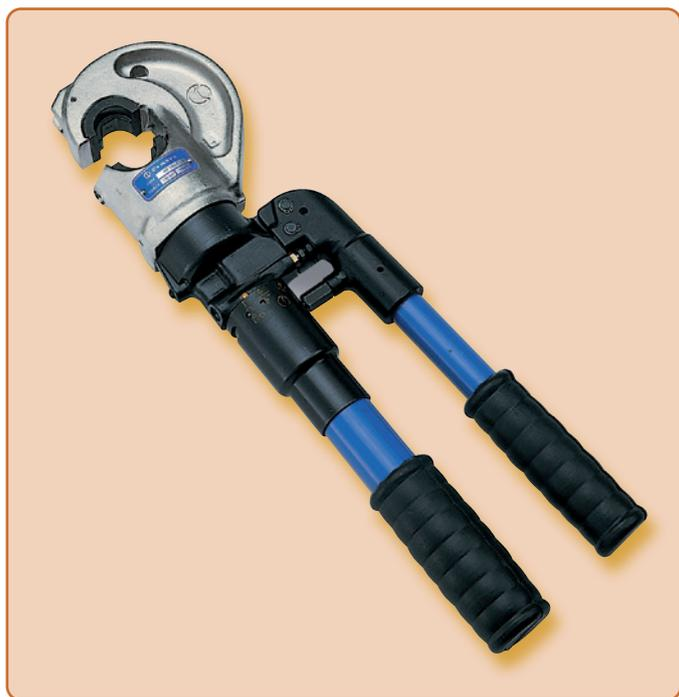
L'**HT131-C** è una pressa manuale idraulica con unità idraulica con due pistoni che garantisce lavori rapidi. La testa girevole di 180° consente un facile maneggiamento. Il sistema di fuoriuscita di pressione integrato può essere azionato facilmente in qualsiasi momento. È disponibile una vasta gamma di teste di pressatura (a pagina 140).
