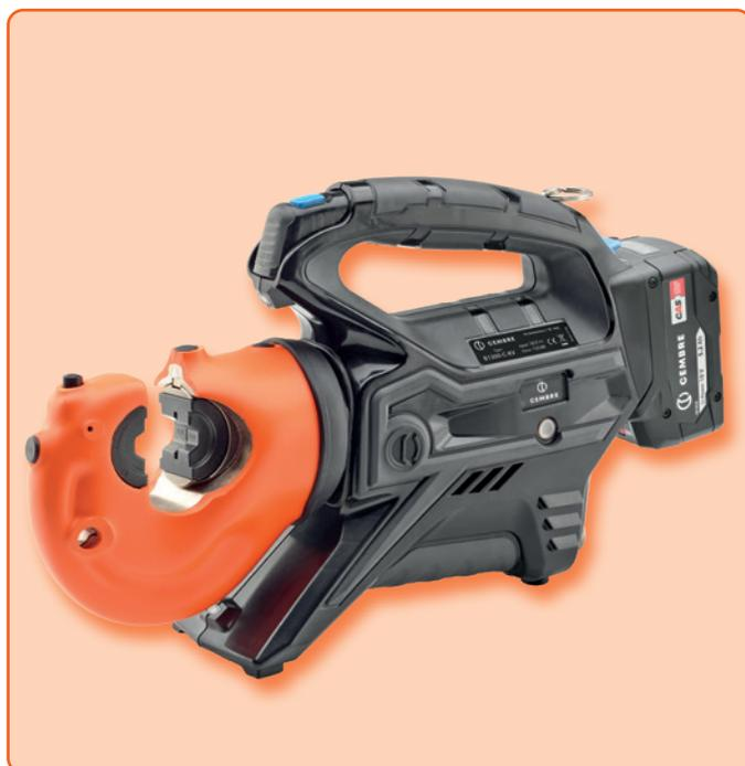
Il utensile di pressatura idraulica isolato a batteria **B1300-C-KV** presenta un dispositivo idraulico a due pistoni. La testa di pressatura è girevole di 180°, pertanto l'applicazione è possibile anche in luoghi stretti. Un chip controlla la modalità di lavoro e spegne automaticamente il motore non appena è realizzata la pressatura. Questo consente di risparmiare energia e di aumentare la durata della batteria.
