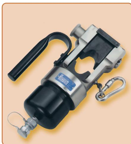
La testa di pressatura idraulica **RHU300-3D** serve per l'inserimento a pressione di linee di alimentazione, capicorda e connettori da 10 a 630 mm<sup>2</sup>. Il utensile è dotato di un raccordo ad attacco rapido senza fuoriuscite d'olio che consente il collegamento ad una pompa idraulica con una pressione di esercizio massima di 850 bar (vedere le pompe idrauliche a pagina 131). È possibile utilizzare teste di pressatura della misura 3 secondo DIN 48083 parte 3.
