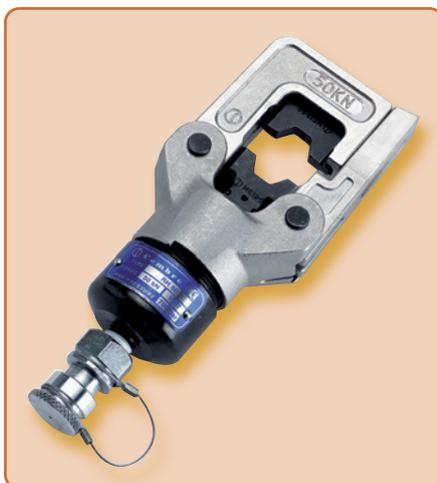
La testa di pressatura idraulica **RH50** è dotata di un raccordo ad attacco rapido senza fuoriuscite d'olio che consente il collegamento ad una pompa idraulica con una pressione di esercizio massima di 700 bar (vedere le pompe idrauliche a pagina 132). È disponibile una vasta gamma di teste di pressatura (a pagina 140).
