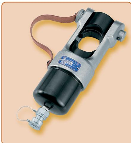
La testa di pressatura idraulica **ECW-H3D** è dotata di un raccordo ad attacco rapido senza fuoriuscite d'olio che consente il collegamento ad una pompa idraulica con una pressione di esercizio massima di 700 bar (vedere le pompe idrauliche a pagina 131). Le teste di pressatura corrispondono alla misura 3 secondo DIN 48083. Grazie all'adattatore **AU230-130D** è possibile utilizzare anche tutte le teste di pressatura dell' utensile 130-kN.
