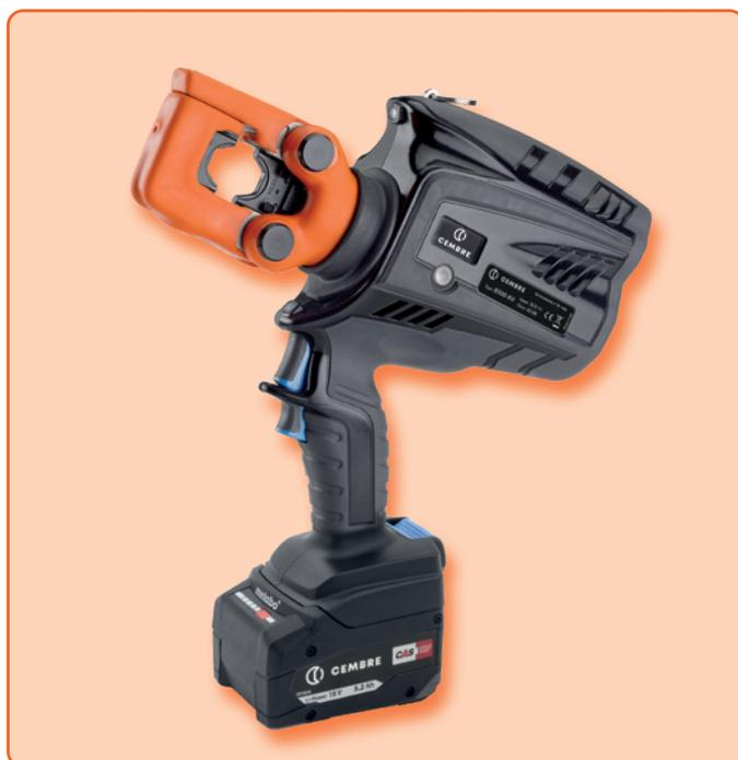
Il utensile di pressatura idraulica isolato a batteria **B500-KV** presenta un dispositivo idraulico a due pistoni. La testa di pressatura è girevole di 180°, pertanto l'applicazione è possibile anche in luoghi stretti. È possibile utilizzare tutte le teste di pressatura secondo DIN 48083, in particolare quelle degli utensili 63 kN. Testa di pressatura idonee a pagina 140.
