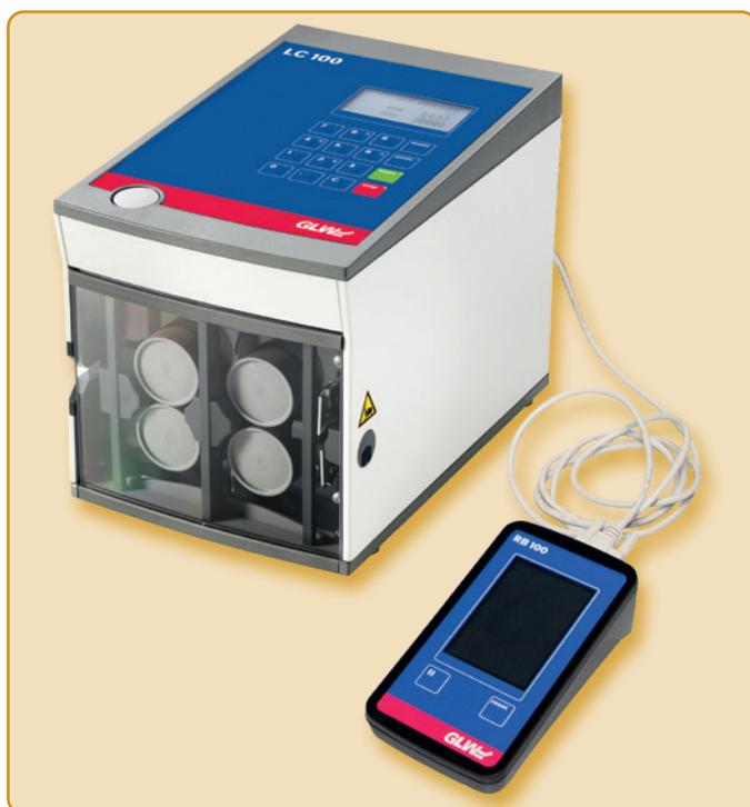
Per tagliare i fili a misura, questo **LC-100RB** è dotato di un controllo esterno. Questo permette di mettere in pausa i lavori per completare altre operazioni, come l'applicazione di marcatori. Il lavoro può essere messo completamente in pausa, il che può essere utile per i progetti più grandi. La velocità di trasporto può essere facilmente adattata al progetto. A questo scopo, la funzione di taglio e il taglio a zero possono essere disattivati.
