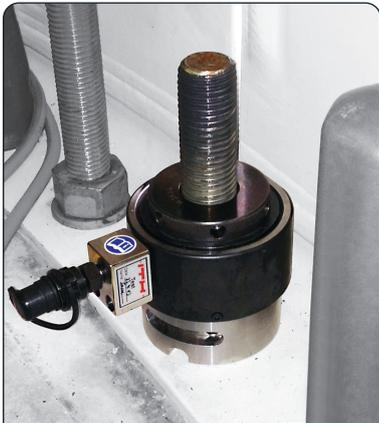
Cilindro tensionatore idraulico
