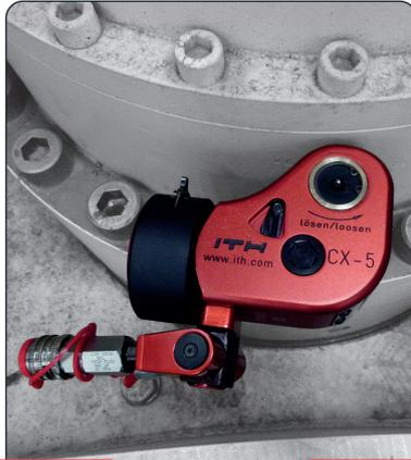
Chiave dinamometrica idraulica
