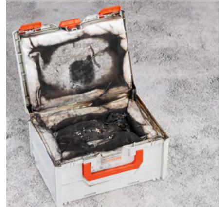
Indispensable pour l'utilisation des appareils fonctionnant sur batterie en entreprise ; les batteries pouvant être défectueuses à tout moment (risque d'incendie).
