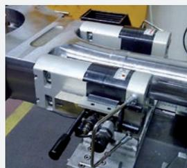
Précharge simultanée de 2 raccords boulonnés avec une distance axiale proche. ITH propose des dimensions de M16 à M52 (3/8" à 2").
