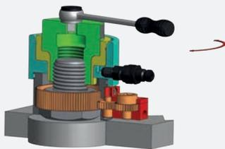
La douille interchangeable du vérin tendeur (BTC) est vissée sur le filetage débouchant. La bague tournante entoure l'écrou.
