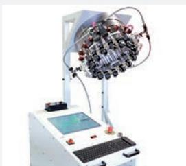
Le système optionnel PSD / PD propose un contrôle automatique et une documentation digitale de la procédure de serrage avec les vérins tendeurs ITH.
