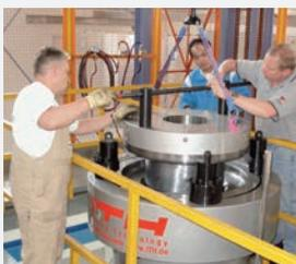
Basé sur une conception simple-étage ITH est capable de livrer des vérins tendeurs jusqu'à M 800 (31 1/2"). Ils sont appliqués comme sur cet arbre principal d'une turbine à gaz.
