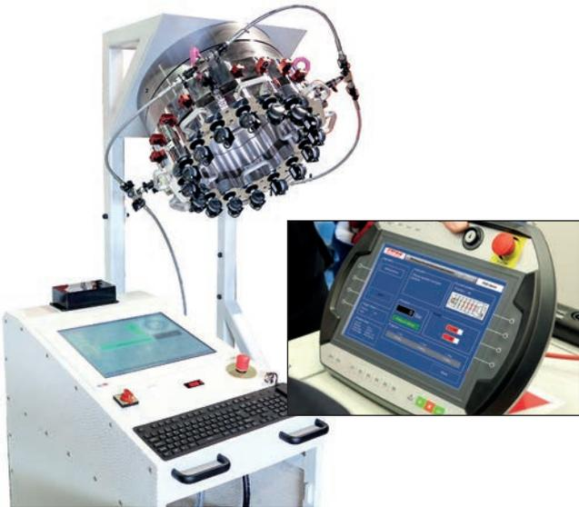
**Le PD / PSD-System** est un système de gestion digitale applicable à quasiment toutes les applications nécessitant un vérin tendeur ITH
