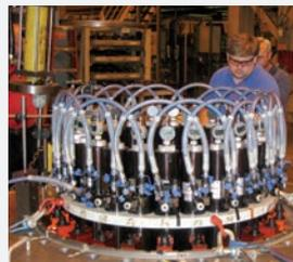
Serrage simultané de plusieurs boulons en même temps, comme sur ces boulons de turbine de rotor 2.5" – 8 UN
