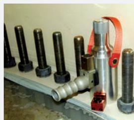
Il est souvent recommandé de serrer des tiges d'ancrage ou autres boulons de fondation avec des vérins, car aucun effet de flexion ni de torsion n'apparaît durant leur utilisation.
