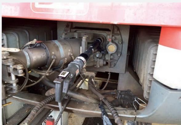
Élargissez vos options d'applications avec la large gamme d'accessoires ITH tels que que les serrages déportés ou les extension de couple, ici utilisé sur une EDS 250.
