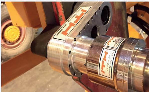
Le serrage déporté ITH offre des points de réaction tout autour des assemblages boulonnés.
