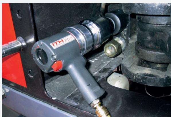
Cette assemblage boulonné d'embrayage M36 (1 3/8") d'un tracteur est serré avec une PDS 250.
