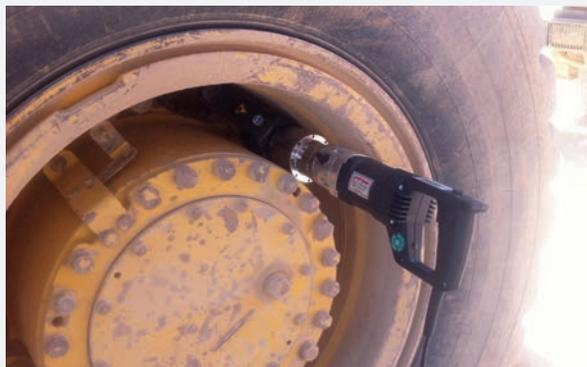
Les extensions de couple ITH sont utilisées sur des applications dans des espaces limités. Voir un autre exemple d'application en page 7.
