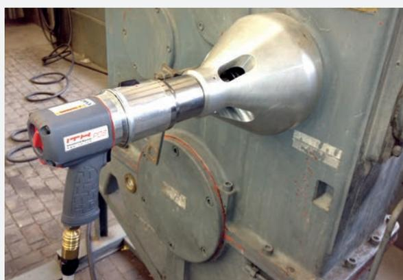
Supports personnalisés (bras d'appui) peuvent être délivrés pour toutes les visseuses ITH. Ce support conique a été utilisé pour le serrage de boulons d'une machine d'incinération des déchets avec une PDS 250 ITH.
