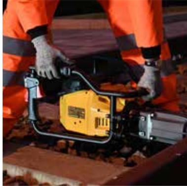
Double accélérateur pour permettre une utilisation pratique en position verticale et horizontale
