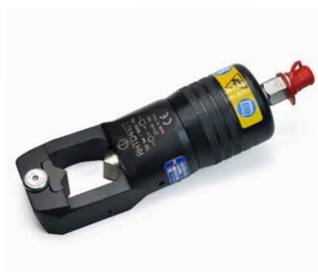
Tête hydraulique casse-écrous avec des dimensions hexagonales allant de 27 mm à 41 mm ; elle est équipée d'un raccord rapide pour le raccordement à une pompe d'une pression de service de 700 bar.
