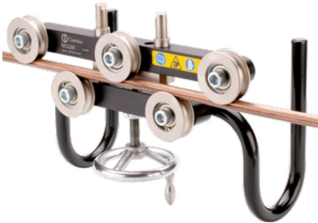
Le rectifieur mécanique pour fils de contact profilés permet de rectifier facilement et de façon continue les sections de fil les plus courantes telles que : 100-120-150 mm<sup>2</sup>.
