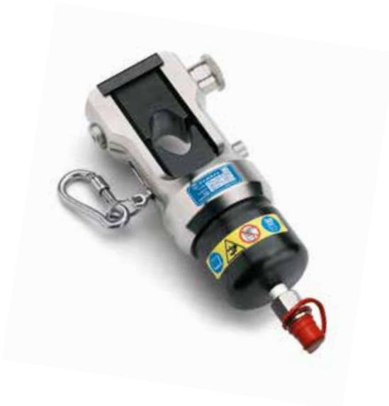
Tête de sertissage hydraulique équipée d'un raccord automatique pour le raccordement à une pompe hydraulique d'une pression maximale de 850 bar. L'adaptateur **AU240-130C** est disponible en option supplémentaire, permettant à la tête de compression d'utiliser les matrices à flûte semi-circulaire, courantes sur la plupart des outils 130 kN.
