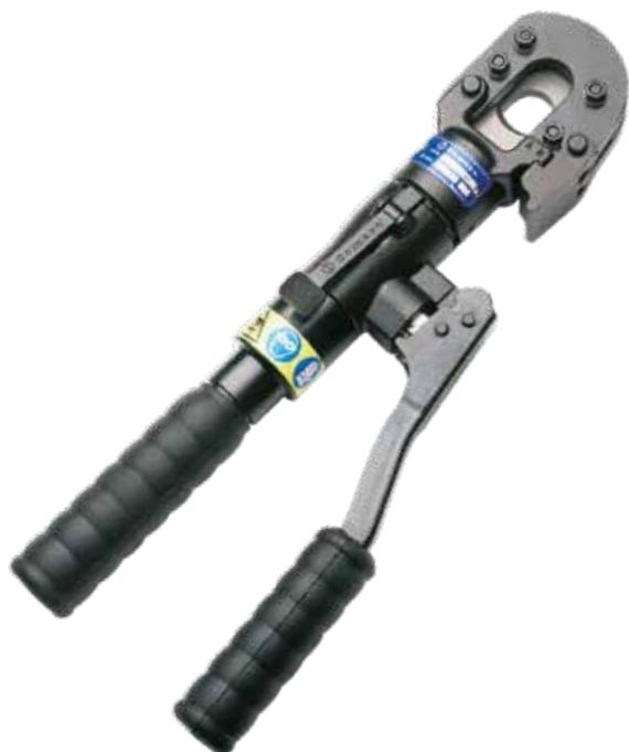
Coupe-câble hydraulique manuel étudié pour sectionner les câbles métalliques en cuivre, almélec, aluminium, aluminium-acier, stay wire et acier avec diamètre maximal globale de 25 mm et barres de mise à la terre en acier jusqu'à 16 mm.
