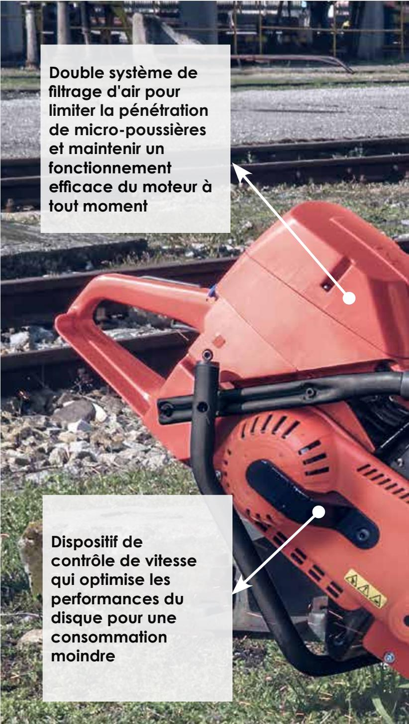
Double système de filtrage d'air pour limiter la pénétration de micro-poussières et maintenir un fonctionnement efficace du moteur à tout moment
