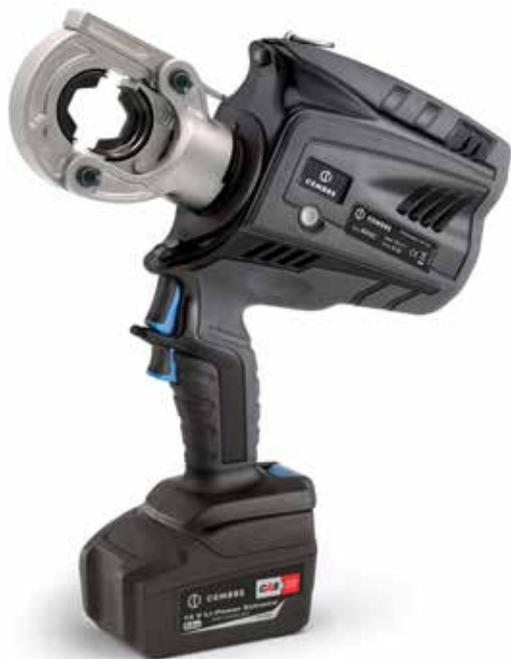
L'outil **B600C** est conçu pour le sertissage de connecteurs jusqu'à 300 mm<sup>2</sup> avec les matrices des têtes 50 kN de chez CEMBRE, utilisé avec les matrices MK et MH et les connecteurs DR et HR par CEMBRE selon les normes industrielles allemandes développé. Le système composé d'outils, de matrices et de connecteurs est certifié UL.
