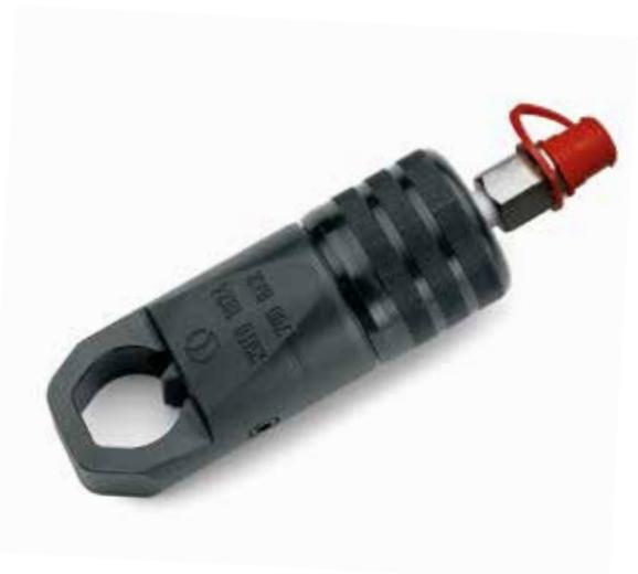
Tête hydraulique casse-écrous avec des dimensions hexagonales allant de 16 mm à 27 mm ; elle est équipée d'un raccord rapide pour le raccordement à une pompe d'une pression de service de 700 bar.
