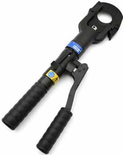
Coupe-câble hydraulique manuel de nouvelle conception, destiné à sectionner les câbles cuivre et aluminium de diamètre 50 mm maximum. Ses caractéristiques techniques permettent également de couper les câbles téléphoniques. Il est équipé de deux vitesses de montée du piston: rapide jusqu'au contact des lames avec le câble, lente pour le sectionnement.
