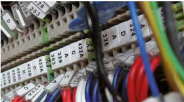
Les repères **MG-CPM** permettent d'identifier les borniers de différents fabricants; ils se fixent sur ces borniers au moyen des griffes inférieures dont ils sont pourvus. Selon le type, les repères sont disposés en bandes modulaires rigides, en bandes modulaires extensibles, ou en individuel.
