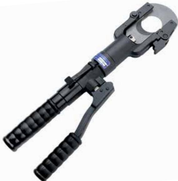
Coupe-câble hydraulique manuel étudié pour sectionner les câbles en cuivre, aluminium, aluminium-acier (ACSR) avec diamètre maximal global de 50 mm.
