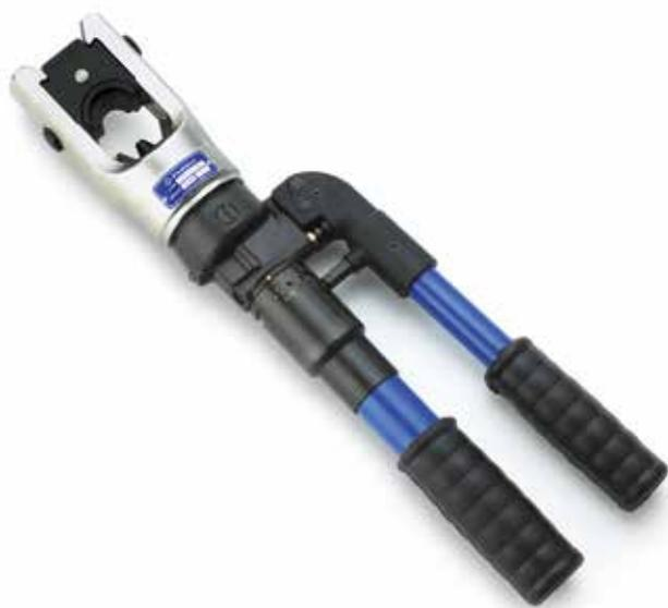
Modèle plus compact, robuste et maniable, adaptée pour la réalisation des connexions électriques sur câble Aluminium (selon la HN 68S90), utilisant la technique du poinçonnage profond. Elle utilise également les matrices semi-circulaires communes à toutes les presses hydrauliques d'une force de 130 kN.
