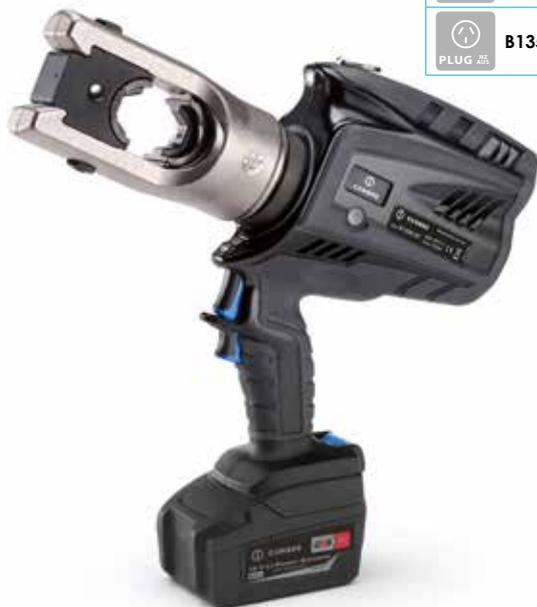
L'outil **B1350-UC** est conçu pour le sertissage de connecteurs en cuivre jusqu'à 400 mm<sup>2</sup> et en aluminium par poinçonnage profond, avec les matrices des têtes 130 kN de chez CEMBRE. Livré complet avec adaptateur **AU130-C** pour l'utilisation de la série de matrices semi-circulaire commune à tous les outils développant une force de 130 kN.
