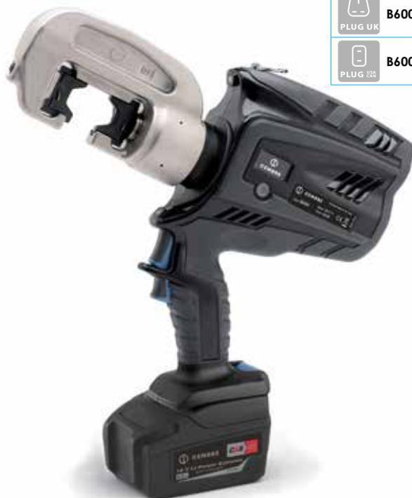
L'outil **B600** est conçu pour le sertissage de connecteurs jusqu'à 300 mm<sup>2</sup> avec les matrices des têtes 50 kN de chez CEMBRE, utilisé avec les matrices MK et MH et les connecteurs DR et HR par CEMBRE selon les normes industrielles allemandes développé. Le système composé d'outils, de matrices et de connecteurs est certifié UL.
