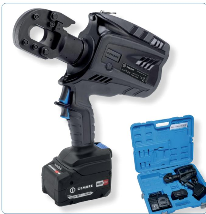
Outil hydraulique portable à deux vitesses sur batterie **B-TC026** conçu pour couper des câbles en cuivre, aluminium, almelec, acier et aluminium/acier avec diamètre maximal global de 25mm. La tête tourne jusqu'à 180° pour une meilleure utilisation dans les espaces réduits.
