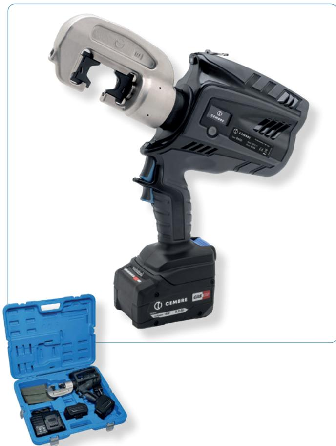
Outil portable sur batterie B600 à deux vitesses. La tête tourne jusqu'à 180° pour une meilleure utilisation dans les espaces réduits. Tous les matrices selon DIN48083 en particulier celles des têtes 68 kN de chez Cembre (ressort nécessaire pour l'ouverture) peuvent être utilisés. Pour plus de détails veuillez consulter le tableau dès page 60.
