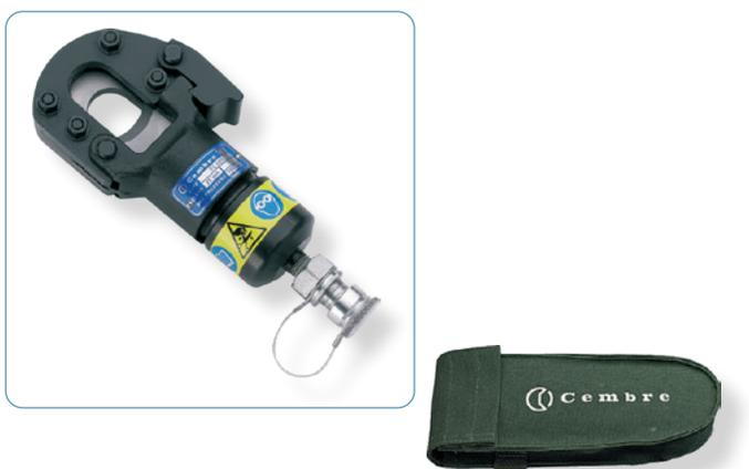
La tête de coupe hydraulique **TC025** est particulièrement adaptée pour couper les caténaires, les câbles conducteurs et les matériaux ronds. Les lames de coupe sont fabriquées avec un alliage d'acier de très haute qualité. L'outil est équipé d'un raccord rapide sans fuite d'huile qui permet le raccordement à une pompe hydraulique d'une pression nominale maximale de 700 bar (page 48).
