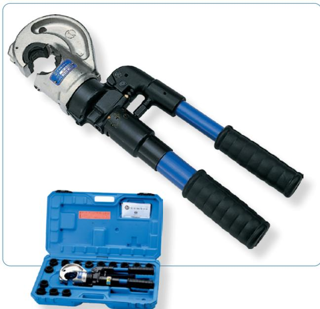
Cette presse manuelle hydraulique **HT131-C** est adaptée pour le sertissage de matériel de raccordement de 10 à 400 mm<sup>2</sup>. L'outil est muni d'un clapet de sécurité qui déclenche lorsque la pression maximale de 700 bar est atteinte. La tête peut pivoter de 180°. Le système hydraulique intégré à double piston permet un travail très rapide. Pour la plage d'utilisation de l'outil et des matrices qui s'y rapportent, respecter le tableau à partir de la page 60.
