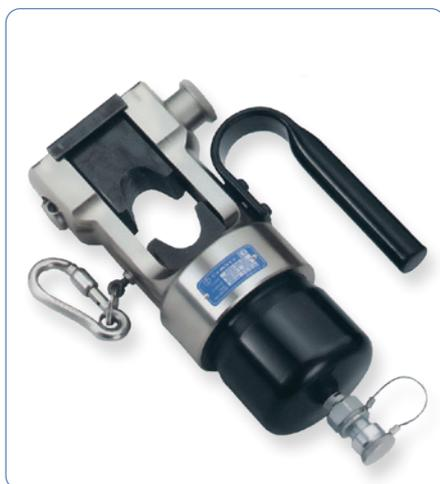
La tête de sertissage hydraulique **RHU300-3D** est adaptée pour le sertissage des caténaires, des cosses de câble et des connecteurs de 10 à 630 mm<sup>2</sup>. L'outil est équipé d'un raccord rapide sans fuite d'huile qui permet le raccordement à une pompe hydraulique (page 48) avec une pression de service maximale de 850 bar. Il est possible d'utiliser des matrices de sertissage de la taille 3 selon la DIN 48083 partie 3.
