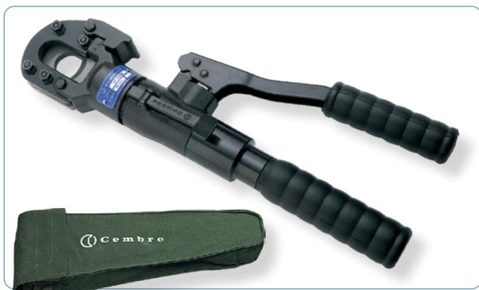
L'outil de coupe hydraulique manuel **HT-TC026** avec système hydraulique à double piston est particulièrement adapté pour couper les caténaires, les câbles conducteurs et les matériaux ronds. L'outil est muni d'un clapet de sécurité qui déclenche lorsque la pression maximale de 700 bar est atteinte. La tête peut pivoter de 180°. Les lames de coupe sont fabriquées avec un alliage d'acier de très haute qualité.
