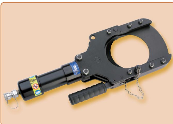
La tête de coupe hydraulique **TC120** est conçue pour couper des câbles avec un diamètre maximal de 120 mm. Grâce à sa fermeture rabattable pratique, elle est facile d'utilisation. La coupe particulière et la forme spéciale des lames garantissent une « coupe droite ». L'outil est équipé d'un accouplement rapide sans perte d'huile, qui permet le raccordement à une pompe hydraulique avec une pression de service maximale de 700 bar (voir pompes hydrauliques, à partir de la page 131).
