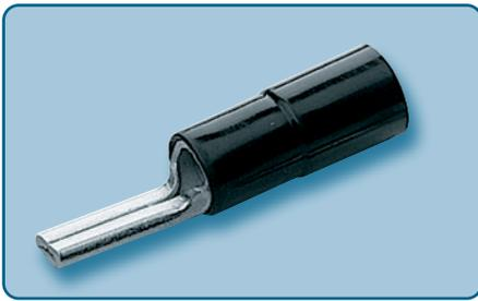
Les cosses ANE-P sont réalisées à partir d'un méplat en cuivre électrolytique, roulé et brasé. Le revêtement est un étamage électrolytique. La jupe isolante Nylon possède à l'intérieur, un cône d'entrée, facilitant la mise en place du conducteur. L'outillage spécifique à ces cosses est seul habilité à garantir la qualité de la connexion, tant sur le plan électrique que mécanique. Les cosses ANE-P sont particulièrement destinées à raccorder des conducteurs à fils fins.
