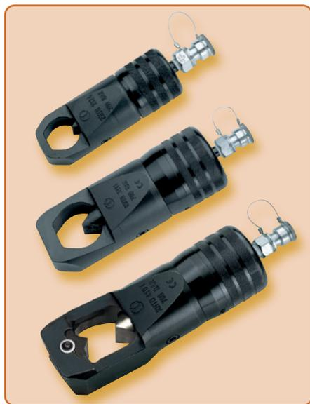
Ces outils sont adaptés au serrage d'écrous carrés et hexagonaux ainsi que des douilles de fixation (voir tableau). Les travaux exigeants et générant des étincelles comme le ponçage ou la séparation ne sont plus requis. Les casse-écrous hydrauliques sont équipés d'un accouplement rapide sans perte d'huile, qui permet le raccordement à une pompe hydraulique avec une pression de service maximale de 700 bar (voir pompes hydrauliques, à partir de la page 131).
