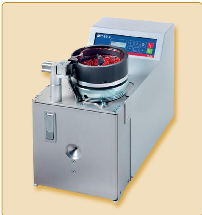
Les appareils à dénuder et à sertir électropneumatiques **MC-40-1** et **MC-40L** servent à traiter de manière rationnelle les embouts en vracs avec une collerette en plastique. Le dénudage et le sertissage sont effectués en une seule opération.
