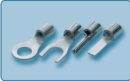
Les cosses de la série "S" sont réalisées à partir d'un méplat en cuivre, revêtu d'un étamage électrolytique. Le fût brasé permet d'effectuer un sertissage identique à un tube. L'intérieur strié du fût améliore, après sertissage, le contact avec les brins du câble, et la résistance à la traction. Pour le sertissage, utiliser les outils mentionnés page 85.
