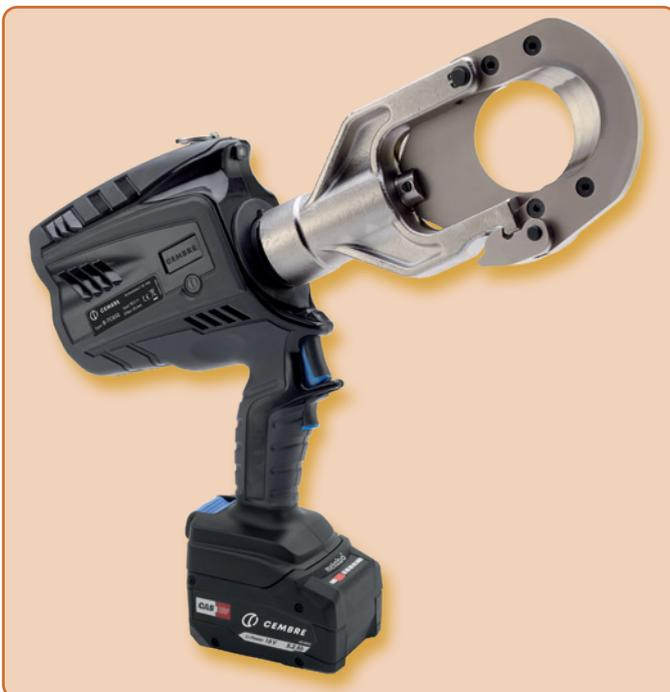
L'outil de coupe hydraulique sur batterie **B-TC650** avec système hydraulique à double piston est conçu pour couper des câbles en cuivre, en aluminium et de téléphone avec un diamètre maximal de 65 mm. Grâce à la fermeture rabattable de la tête, l'outil peut également être utilisé pour couper un matériau sans fin. Grâce à sa tête rotative à 335°, il est très facile d'utilisation.
