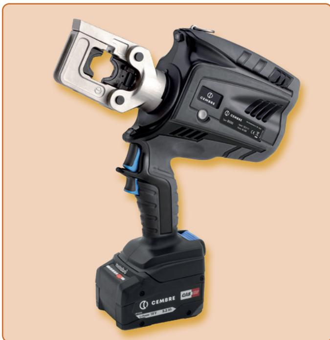
La presse hydraulique sur batterie **B500** dispose d'un système hydraulique à double piston. Grâce à sa tête de presse rotative à 180°, elle peut être utilisée dans des espaces très exigus.
