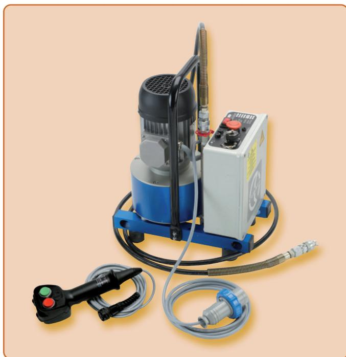
La pompe électrohydraulique 220 V **CPE-1** fonctionne avec un moteur monophasé et une pression de service maximale de 700 bar. La commande de la pompe est effectuée par une télécommande manuelle. Sur la pompe, il est également possible d'évacuer la pression à n'importe quel moment en appuyant sur un bouton. Un modèle pour 110 V est également disponible. Les deux modèles ont l'indice de protection IP55.
