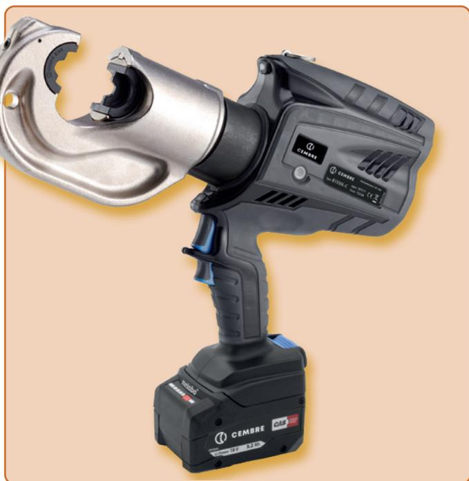
La presse hydraulique sur batterie **B1350L-C** dispose d'un système hydraulique à double piston. Grâce à sa tête de presse rotative à 180°, elle peut être utilisée dans des espaces très exigus. L'ouverture de la tête est de 42 mm et est conçue en particulier pour la compression de sections plus grandes. Matrices adaptées à partir de la page 140.
