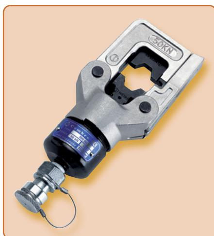
La tête de presse hydraulique **RH50** est équipée d'un accouplement rapide sans perte d'huile, qui permet le raccordement à une pompe hydraulique avec une pression de service maximale de 700 bar (voir pompes hydrauliques, à partir de la page 132). Une gamme complète de matrices est disponible (à partir de la page 140).
