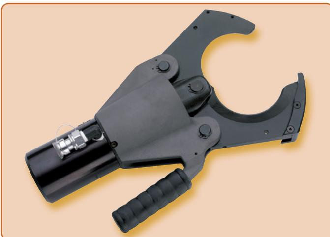
La tête de coupe hydraulique **TC096** est conçue pour couper des câbles avec un diamètre maximal de 95 mm. Sur ce modèle de tête de coupe ouvert, le guidage des lames permet d'éviter que les matériaux à couper ne se coincent ou ne s'inclinent. L'outil est équipé d'un accouplement rapide sans perte d'huile, qui permet le raccordement à une pompe hydraulique avec une pression de service maximale de 700 bar (voir pompes hydrauliques, à partir de la page 131).
