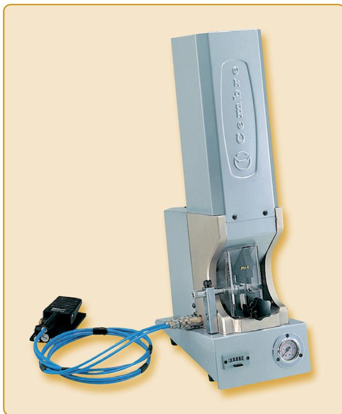
Presse d'établi pneumatique à commande manuelle avec une grande diversité d'utilisation. Grâce à un grand choix de matrices interchangeable, elle convient pour les embouts de câble isolés et non isolés, les cosses transversales, les connecteurs plats et les cosses tubulaires de 0.2 - 50mm<sup>2</sup>. La **PNB-1** se distingue en outre par ses petites dimensions et son faible poids.
