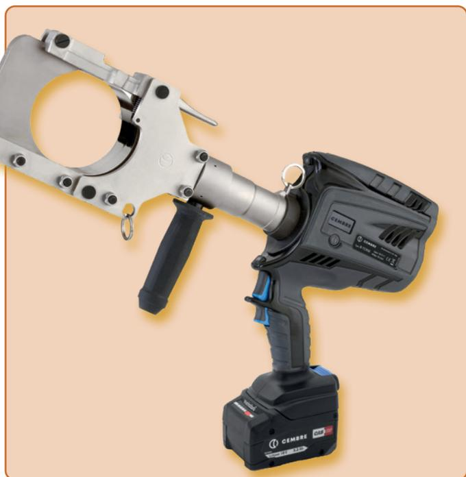
L'outil de coupe hydraulique sur batterie **B-TC950** avec système hydraulique à double piston est conçu pour couper des câbles en cuivre et en aluminium avec un diamètre maximal de 95 mm. Grâce à la fermeture rabattable de la tête, l'outil peut également être utilisé pour couper un matériau sans fin. Grâce à sa tête rotative à 335°, il est très facile d'utilisation.
