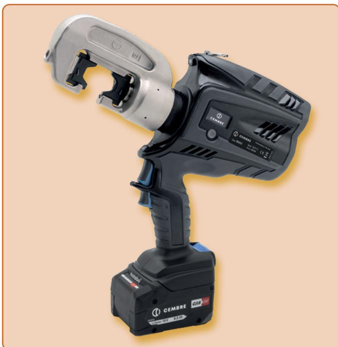
La presse hydraulique sur batterie **B600** dispose d'un système hydraulique à double piston. Grâce à sa tête de presse rotative à 180°, elle peut être utilisée dans des espaces très exigus. Toutes les matrices selon DIN 48083 peuvent être utilisées, en particulier celles des outils de 68 kN (ressort d'ouverture requis). Les matrices à tourillon de taille 1 d'autres fabricants peuvent également être utilisées. Matrices adaptées à partir de la page 140.
