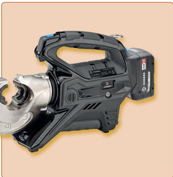
La presse hydraulique sur batterie **B1300-C** dispose d'un système hydraulique à double piston. Grâce à sa tête de presse rotative à 180°, elle peut être utilisée dans des espaces très exigus. Une puce contrôle le fonctionnement et arrête automatiquement le moteur lorsque la compression est effectuée. Cela permet d'économiser de l'énergie et de prolonger la durée de vie de la batterie. Matrices adaptées à partir de la page 140.
