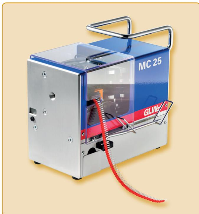
Votre outil rationnel pour le traitement d'embouts de câbles isolés. Le **MC25** traite les embouts en bande de 0.25 – 2.5 mm<sup>2</sup> / longueur standard de 8 mm. Grâce à son format compact, il peut également être utilisé sur des postes de travail changeant.
