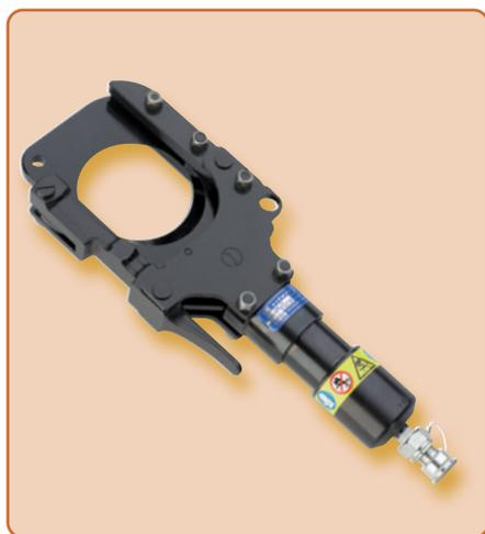
La tête de coupe hydraulique **TC085** est conçue pour couper des câbles avec un diamètre maximal de 85 mm (par ex. 4 x 240 mm<sup>2</sup> NYY-0). La coupe particulière et la forme spéciale des lames garantissent une « coupe droite ». L'outil est équipé d'un accouplement rapide sans perte d'huile, qui permet le raccordement à une pompe hydraulique avec une pression de service maximale de 700 bar (voir pompes hydrauliques, à partir de la page 131).
