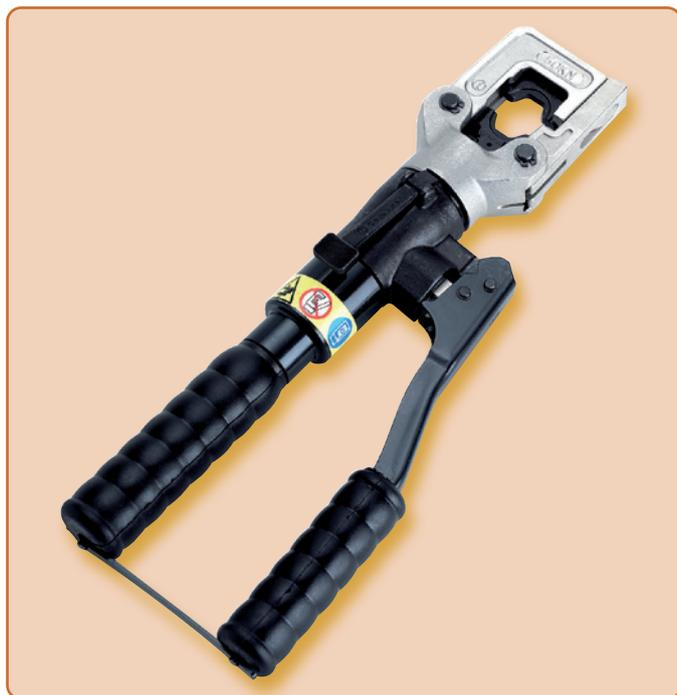
La presse manuelle hydraulique **HT51** est parfaitement adaptée aux travaux dans des espaces très exigus. Le nouveau système hydraulique à double piston permet un sertissage rapide, même pour les sections les plus petites. La presse est facile d'utilisation grâce à sa tête rotative à 180°. Le système de décompression intégré peut être facilement actionné à tout moment. Une gamme complète de matrices est disponible (à partir de la page 140).
