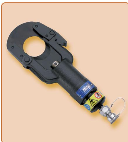
La tête de coupe hydraulique **TC050** est conçue pour couper des câbles avec un diamètre maximal de 50 mm (par ex. 4 x 150 mm<sup>2</sup> NYY-0). La coupe particulière et la forme spéciale des lames garantissent une « coupe droite ». L'outil est équipé d'un accouplement rapide sans perte d'huile, qui permet le raccordement à une pompe hydraulique avec une pression de service maximale de 700 bar (voir pompes hydrauliques, à partir de la page 131).
