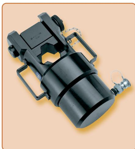
La tête de presse hydraulique **RHU520** est équipée d'un accouplement rapide sans perte d'huile, qui permet le raccordement à une pompe hydraulique avec une pression de service maximale de 700 bar (voir pompes hydrauliques, à partir de la page 131). Avec l'adaptateur (type **AU 520-130C**), toutes les matrices des outils de 130 kN de Cembre peuvent également être utilisées avec le **RHU520**.
