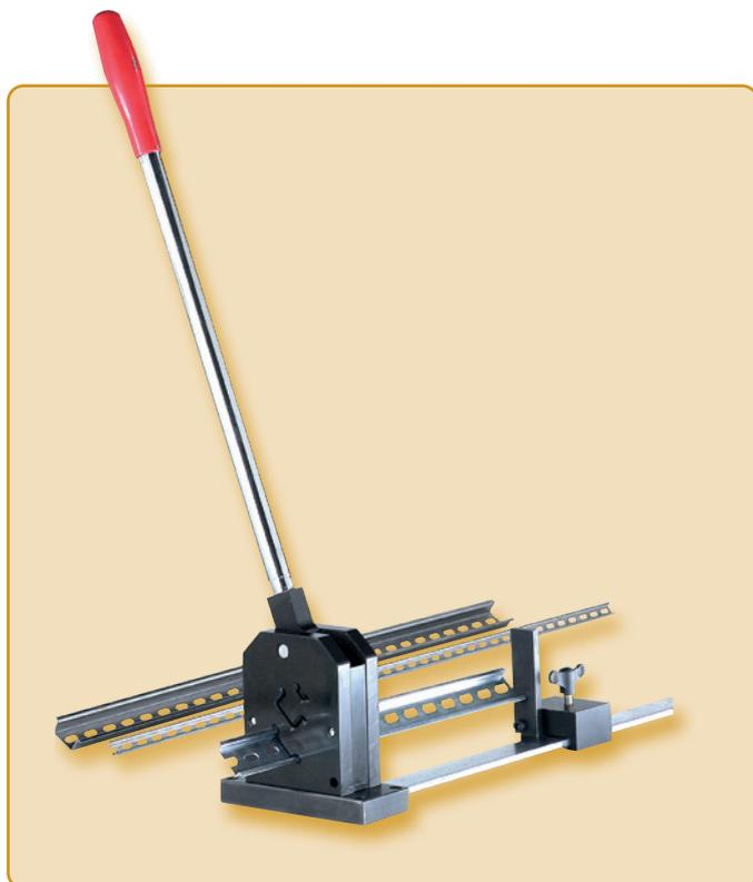
Pour la coupe rapide et précise de rails supports DIN EN 60715. Le **RC-300** sert à couper des rails supports (rails chapeaux) des dimensions TH 35-15, TH 35-7.5 et TH 15-5.5. Le **RC-300** coupe rapidement et sans bavures aux longueurs souhaitées, sans effort important. À l'aide du rail de mesure de 1 m, les rails supports sont coupés au millimètre près. Les arêtes sont coupées avec un angle précis et ne nécessitent pas de finitions. Le poste de travail reste propre et exempt de copeaux.
