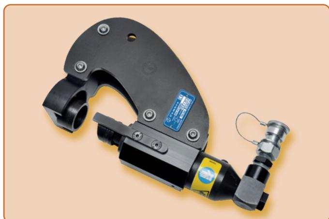
Tête de perçage hydraulique pour le perçage de trous d'un diamètre de 15.5 à 47.2 mm sans avoir à percer dans les parois des goulottes de câblage. L'outil est très léger et équilibré, et peut être utilisé d'une seule main.
