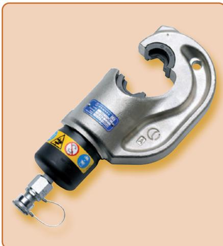
La tête de presse hydraulique **RHC131LN** est équipée d'un accouplement rapide sans perte d'huile, qui permet le raccordement à une pompe hydraulique avec une pression de service max. de 700 bar (voir pompes hydrauliques, à partir de la page 131). Pour le **RHC131LN**, l'ouverture de la tête est de 42 mm. Il est donc particulièrement adapté à la compression de sections plus grandes. Une gamme complète de matrices est disponible (à partir de la page 140).
