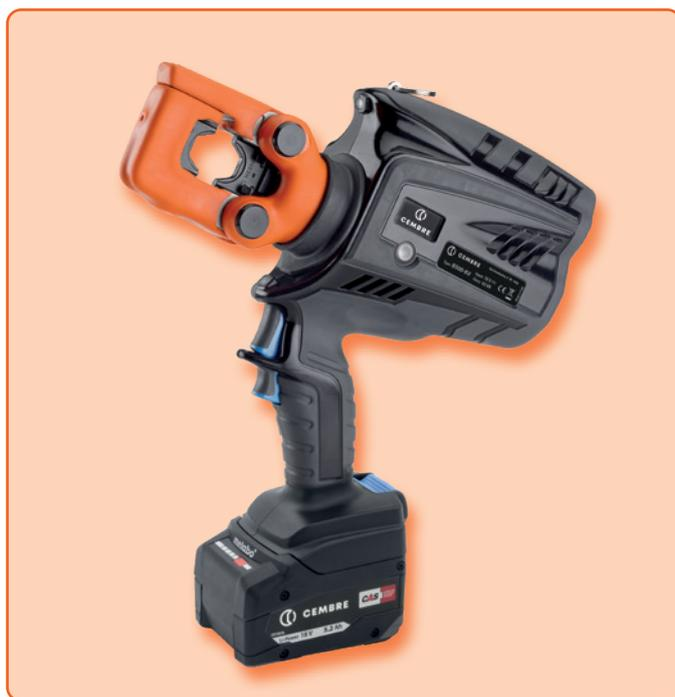
La presse hydraulique isolée sur batterie **B500-KV** dispose d'un système hydraulique à double piston. Grâce à sa tête de presse rotative à 180°, elle peut être utilisée dans des espaces très exigus. Toutes les matrices selon DIN 48083 peuvent être utilisées, en particulier celles des outils de 63 kN. Matrices adaptées à partir de la page 140.
