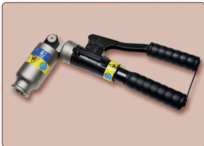
Outil emporte-pièce hydraulique pour le perçage d'acier inox, d'acier, de fibre de verre et de plastique avec une épaisseur de matériau jusqu'à max. 3.5 mm. Compact, léger et facile à manipuler. La tête de perçage peut tourner à 360° et pivoter sur 180°.
