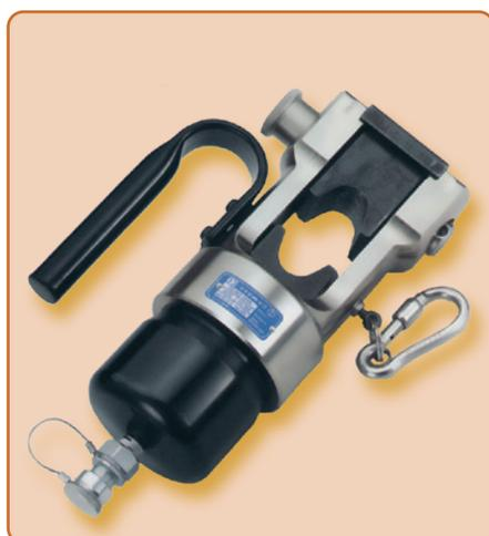
La tête de presse hydraulique **RHU300-3D** est appropriée pour la compression de caténaires, de cosses et de connecteurs de 10 à 630 mm<sup>2</sup>. L'outil est équipé d'un accouplement rapide sans perte d'huile, qui permet le raccordement à une pompe hydraulique avec une pression de service maximale de 850 bar (voir pompes hydrauliques, à partir de la page 131). Des matrices de la taille 3 selon DIN 48083 partie 3 peuvent être utilisées.
