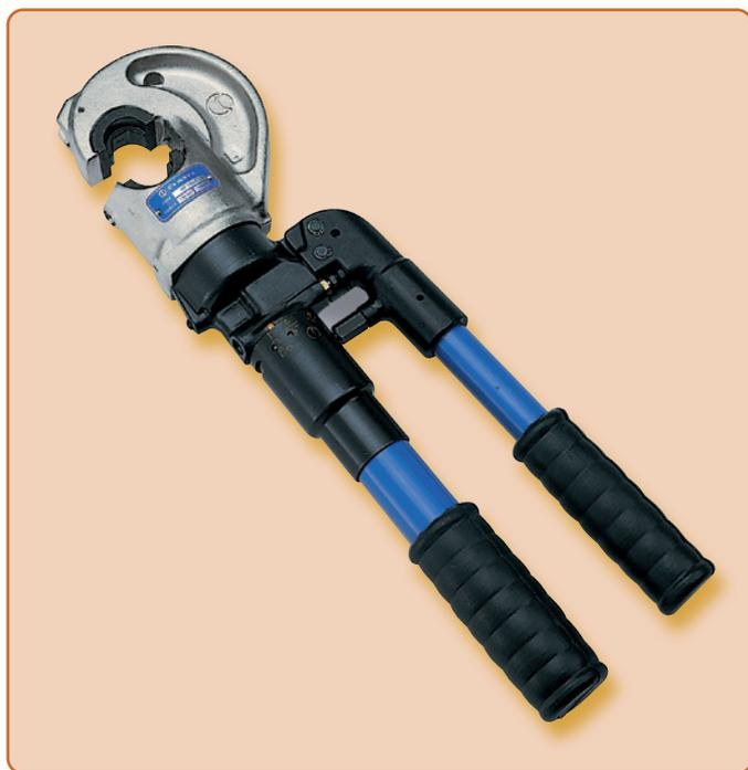
Le **HT131-C** est une presse manuelle hydraulique avec un système hydraulique à double piston qui garantit un travail rapide. La presse est facile d'utilisation grâce à sa tête rotative à 180°. Le système de décompression intégré peut être facilement actionné à tout moment. Une gamme complète de matrices est disponible (à partir de la page 140).
