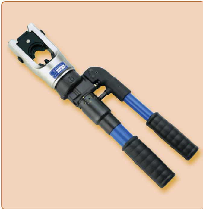
Le **HT131-UC** est une presse manuelle hydraulique avec un système hydraulique à double piston qui garantit un travail rapide. La presse est facile d'utilisation grâce à sa tête rotative à 180°. Le système de décompression intégré peut être facilement actionné à tout moment. Une gamme complète de matrices est disponible (à partir de la page 140).
