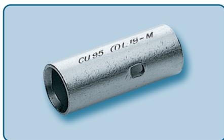
Les manchons de jonction "bout à bout" sont destinés à la basse tension. Ils sont réalisés à partir d'un tube en cuivre électrolytique de mêmes dimensions que pour les cosses T-M. La finition étamage électrolytique leur assure une excellente résistance à la corrosion. Les extrémités sont chanfreinées, facilitant l'introduction des câbles.
