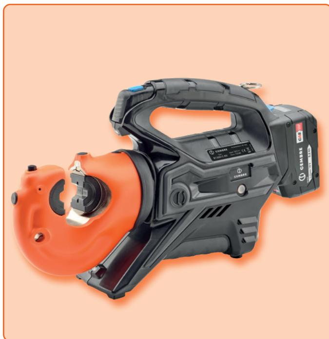
La presse hydraulique isolée sur batterie **B1300-C-KV** dispose d'un système hydraulique à double piston. Grâce à sa tête de presse rotative à 180°, elle peut être utilisée dans des espaces très exigus. Une puce contrôle le fonctionnement et arrête automatiquement le moteur lorsque la compression est effectuée. Cela permet d'économiser de l'énergie et de prolonger la durée de vie de la batterie.
