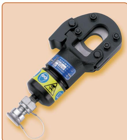
La tête de coupe hydraulique **TC025** est conçue pour couper des câbles en matériaux massifs ou très durs avec un diamètre maximal de 25 mm. Les lames de coupe sont fabriquées dans un matériau de très haute qualité. L'outil est équipé d'un accouplement rapide sans perte d'huile, qui permet le raccordement à une pompe hydraulique avec une pression de service maximale de 700 bar (voir pompes hydrauliques, à partir de la page 131).
