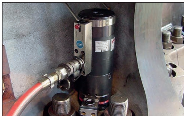
Vorteilhaft bei radial beengten Platzverhältnissen wie an diesem Gehäuse einer Gasturbine: ITH SSZ Typ MSK.
