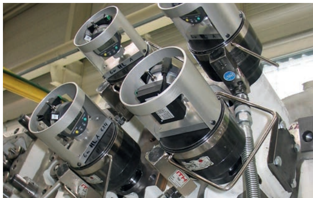
Zylinderkopfmontage eines Gasmotors mit 4 x ITH SSZ Typ ES36-670 mit digitalem Dokumentationssystem PSD.
