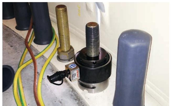
Durch die „offene“ Wechselbuchse kann der ITH SSZ Typ SES auch Schrauben mit langen Gewindeüberständen präzise vorspannen.
