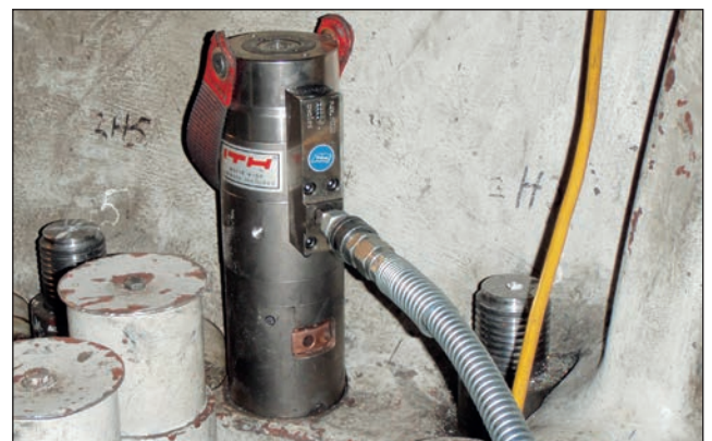
SSZ Typ MS mit NIOX-Beschichtung und Mutternbeistellung durch Beistellöffnung in Abstützung.
