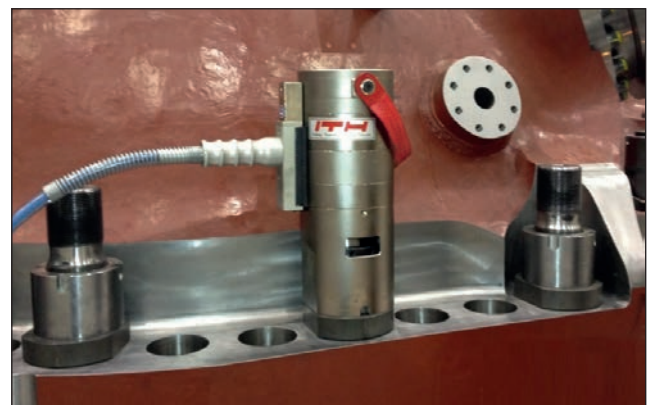
ITH SSZ mit NIOX-Beschichtung, patentiertem Zyklenzähler und patentierter Schutzkappe mit Griffstück.
