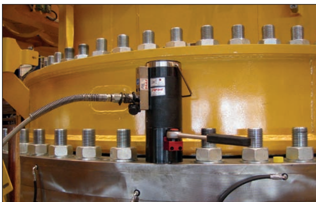
Verschraubung eines doppelt gelagerten Großwälzlagers eines Schienendrehkrans.
