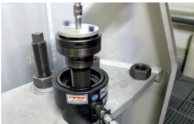
Die flexible Wechselbuchse des ITH SSZ Typ SES wird vor dem Vorspannen auf das überstehende Gewinde aufgeschraubt.
