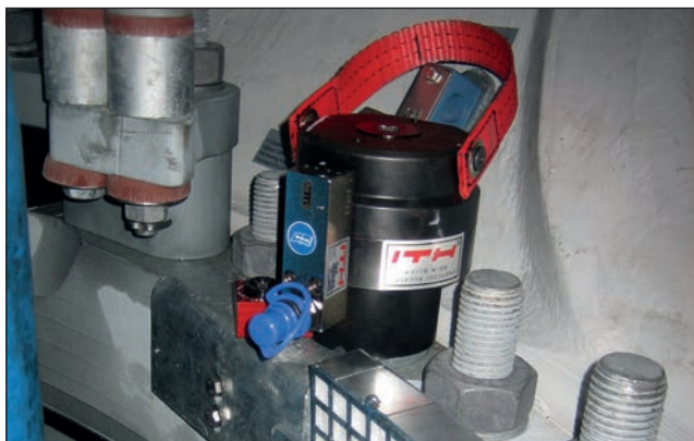
ITH SSZ Typ ES an einer Turmflanschverschraubung einer Windenergieanlage.
