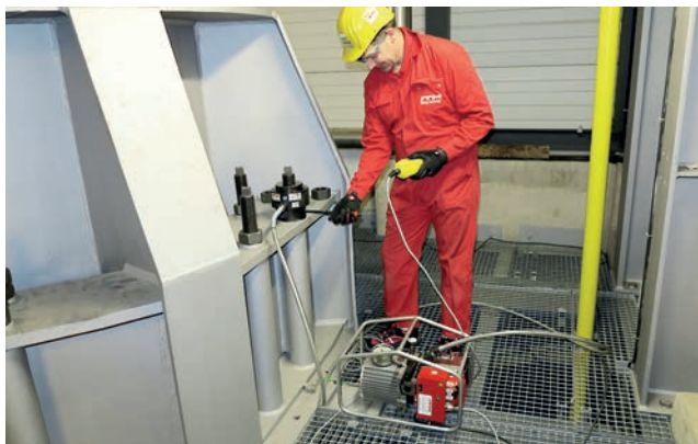
ITH SSZ Typ SES zusammen mit dem ITH Hochdruckaggregat Eco-MAX 18.
