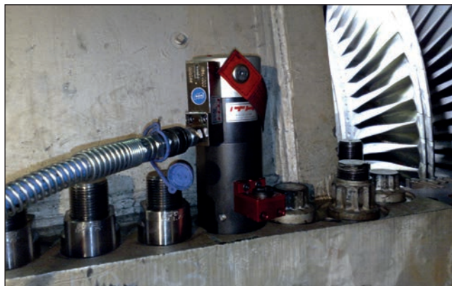
Gehäuseverschraubung einer Gasturbine mit ITH SSZ Typ ES.
