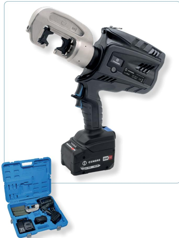
Hydraulische Akkupresse **B600** mit Doppelkolbenhydraulik. Der Presskopf ist um 180° drehbar und somit wird ein Einsatz auf engstem Raum möglich. Es können alle Presseinsätze nach DIN 48083 verwendet werden, insbesondere die der 68 kN Werkzeuge von Cembre (Öffnungsfeder erforderlich). Es können auch Zapfen Presseinsätze Gr. 1 anderer Hersteller eingesetzt werden.
