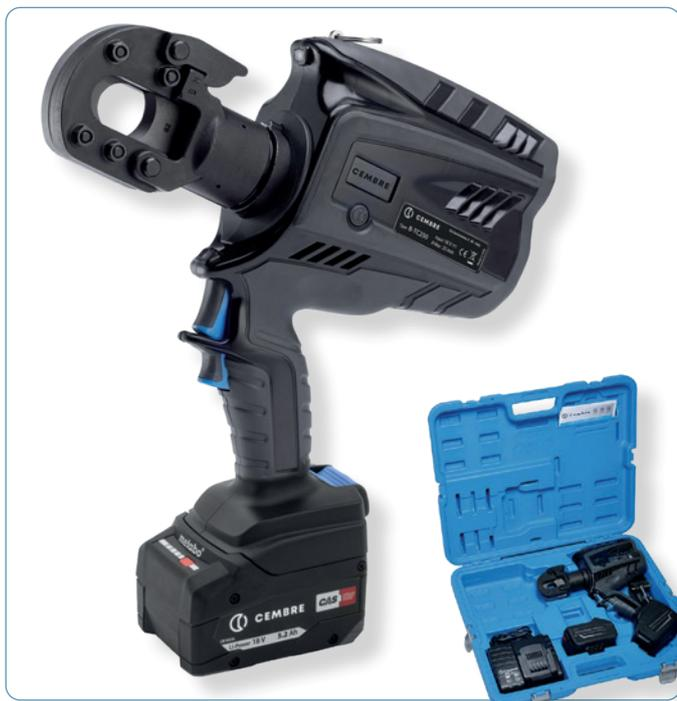
Das hydraulische Akkuschnidwerkzeug **B-TC250** mit Doppelkolbenhydraulik, ist speziell entwickelt worden zum Schneiden von: Kupfer- und Aluminiumkabeln, Aluminium-Stahlseilen, Stahlseilen, Aldreyseilen, Rundmaterial Kupfer, Aluminium, Stahl bis zu einem max. Durchmesser von 25 mm. Das Handling ist durch den um 180° drehbaren Kopf sehr gut gewährleistet. Für den Anwendungsbereich des Werkzeuges beachten Sie die Tabelle ab Seite 62.
