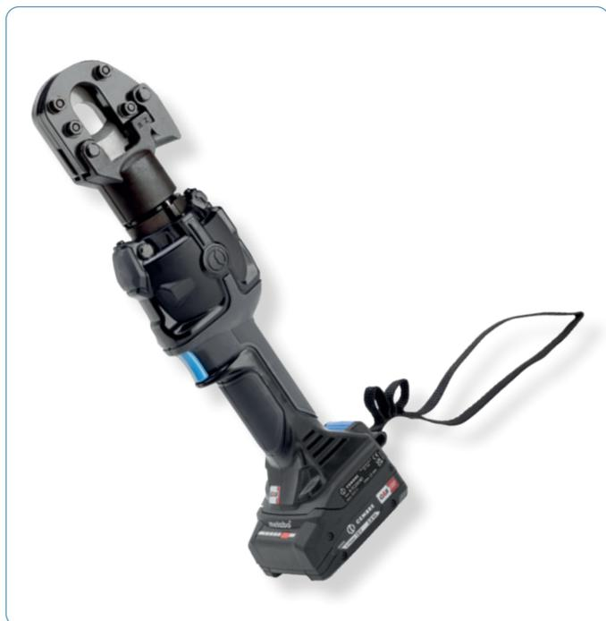
Der Stab-Akkuschneider **B-TC250ND** liegt ausgeglichen in der Hand. Das Werkzeug arbeitet sehr ruhig und vibrationsarm. Es ist geeignet zum Schneiden von massiven oder sehr harten Materialien bis zu einem maximalen Durchmesser von 25 mm. Die Schneidmesser sind deshalb aus besonders hochwertigem Material gefertigt. Der um 180° drehbare Kopf und der praktische Klappverschluss ermöglichen eine einfache Handhabung. Für den Anwendungsbereich des Werkzeuges beachten Sie die Tabelle ab Seite 62.
