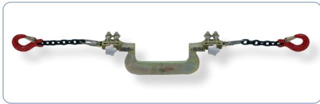
Mit dem Werkzeug **AD-GW** wird die Montage sehr vereinfacht und die Montagezeit von Fahrdrabtstossklemmen auf Rillenfahrdrähten verkürzt. Das Werkzeug wird in den bereits vorhandenen Hubzug mit seinen Fahrdrabtzugklemmen integriert.
