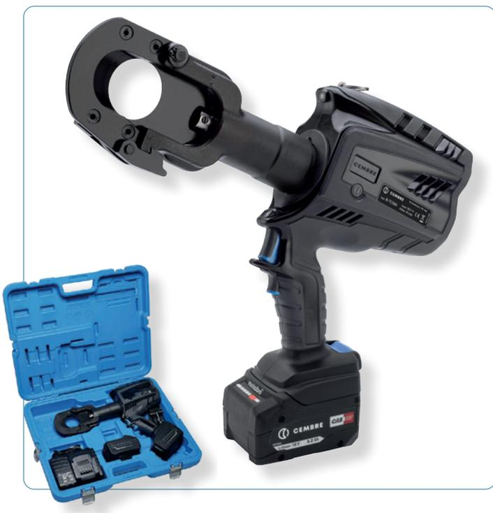
Das hydraulische Akkuschneidwerkzeug **B-TC500** mit Doppelkolbenhydraulik ist speziell entwickelt worden zum Schneiden von Kupfer-, Aluminium- und Telefonkabeln bis zu einem maximalen Durchmesser von 50 mm (z.B. 4 x 150 mm<sup>2</sup> NYY-0). Durch den Klappverschluss des Kopfes kann das Werkzeug auch zum Schneiden von Endlosmaterial eingesetzt werden. Das gute Handling ist durch den um 90° drehbaren Kopf sehr gut gewährleistet.
