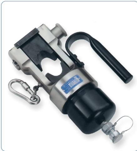
Der hydraulische Presskopf **RHU300-3D** ist geeignet zum Verpressen von Fahrleitungen, Kabelschuhen und Verbindern von 10 bis 630 mm<sup>2</sup>. Das Werkzeug ist mit einer ölverlustfreien Schnellkupplung ausgerüstet, die den Anschluss an eine Hydraulikpumpe (Seite 48) mit einem maximalen Betriebsdruck von 850 bar ermöglicht. Es können Presseinsätze der Grösse 3 nach DIN 48083 Teil 3 verwendet werden.
