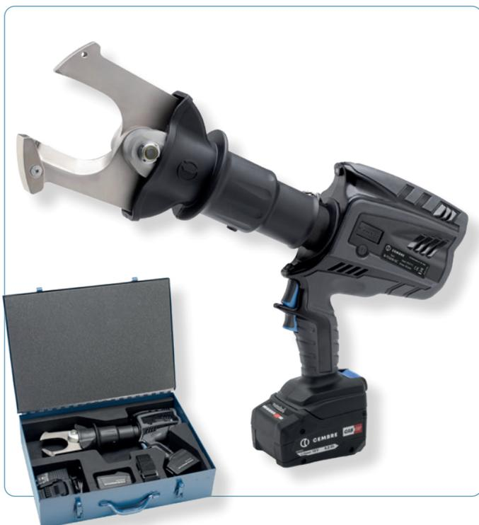
Das hydraulische Akkuschneidwerkzeug **B-TC650-SC** mit Doppelkolbenhydraulik, ist speziell entwickelt worden zum Schneiden von Kupfer-, Aluminium und Telefonkabeln bis zu einem maximalen Durchmesser von 65 mm. Durch die zwei offenen Messer kann das Werkzeug auch zum Schneiden von Endlosmaterial eingesetzt werden. Das gute Handling ist durch den um 335° drehbaren Kopf sehr gut gewährleistet.
