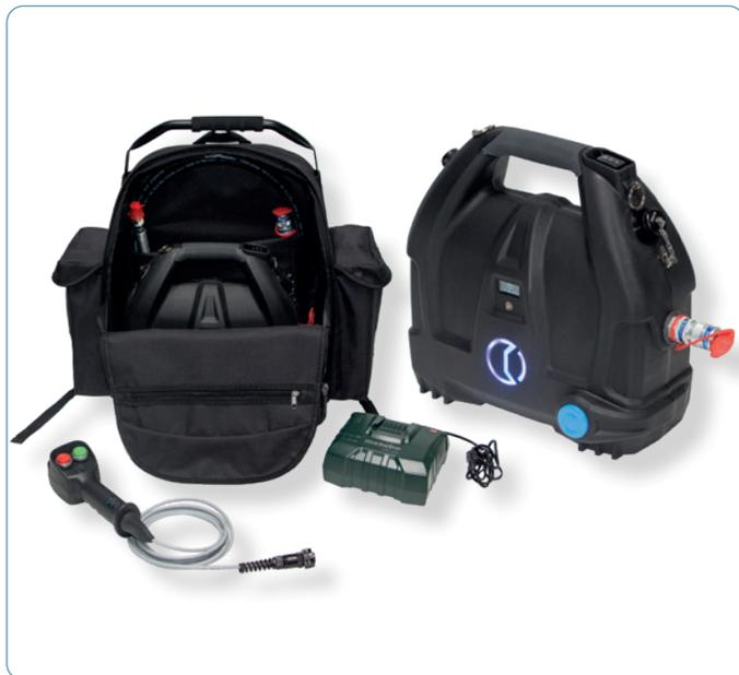
Transportable Elektrohydraulikpumpe mit 36V-Akku mit einem Arbeitsdruck von 700 bar. Die Pumpe arbeitet über einen eingebauten wartungsfreien 36V-Akku und kann durch eine Hand- oder Fusspedalfernbedienung betätigt werden.
