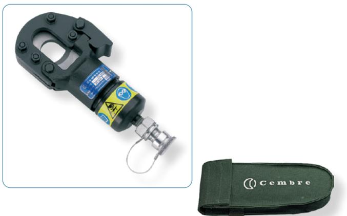
Der hydraulische Schneidkopf **TC025** ist besonders geeignet zum Schneiden von Fahrdrabt, Leiterseilen und Rundmaterialien. Die Schneidmesser sind aus einer sehr hochwertigen Stahllegierung gefertigt. Das Werkzeug ist mit einer ölverlustfreien Schnellkupplung ausgerüstet, die den Anschluss an eine Hydraulikpumpe mit einem max. Betriebsdruck von 700 bar ermöglicht. (Seite 48). Das Werkzeug wird in einer Segeltuchtasche geliefert.
