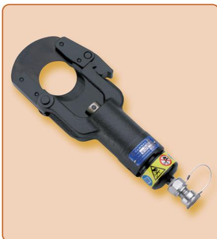
Der hydraulische Schneidkopf **TC050** ist zum Schneiden von Kabeln bis zu einem maximalen Durchmesser von 50 mm (z.B. 4 x 150 mm<sup>2</sup> NYY-0) geeignet. Durch den besonderen Schliff und die spezielle Geometrie der Schneidmesser wird ein «gerader Schnitt» garantiert. Das Werkzeug ist mit einer ölverlustfreien Schnellkupplung ausgerüstet, die den Anschluss an eine Hydraulikpumpe mit einem maximalen Betriebsdruck von 700 bar ermöglicht (siehe hydraulische Pumpen, ab Seite 131).
