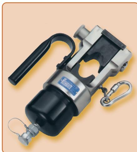
Der hydraulische Presskopf **RHU300-3D** ist geeignet zum Verpressen von Fahrleitungen, Kabelschuhen und Verbindern von 10 bis 630 mm<sup>2</sup>. Das Werkzeug ist mit einer ölverlustfreien Schnellkupplung ausgerüstet, die den Anschluss an eine Hydraulikpumpe mit einem maximalen Betriebsdruck von 850 bar ermöglicht (siehe hydraulische Pumpen, ab Seite 131). Es können Presseinsätze der Grösse 3 nach DIN 48083 Teil 3 verwendet werden.
