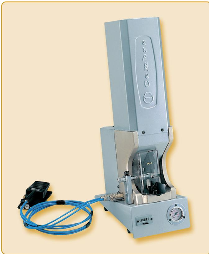
Pneumatische Tischpresse mit manueller Steuerung und grosse Einsatzvielfalt. Dank einer grosse Auswahl an austauschbaren Matrizen, geeignet für isolierte, wie auch unisolierte Aderendhülsen, Queschkabelschuhe, Flachsteckverbinder wie auch Rohrkabelschuhe von 0.2 - 50mm<sup>2</sup>. Die **PNB-1** zeichnet sich ausserdem durch kleine Abmessungen und ihr geringes Gewicht aus.
