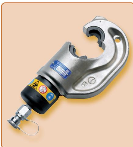
Der hydraulische Presskopf **RHC131LN** ist mit einer ölverlustfreien Schnellkupplung ausgerüstet, die den Anschluss an eine Hydraulikpumpe mit einem max. Betriebsdruck von 700 bar ermöglicht (siehe hydraulische Pumpen, ab Seite 131). Beim **RHC131LN** beträgt die Öffnungsweite des Kopfes 42 mm. Er ist deshalb besonders zum Verpressen von grösseren Querschnitten geeignet. Es steht eine umfangreiche Palette von Presseinsätzen zur Verfügung (ab Seite 140).
