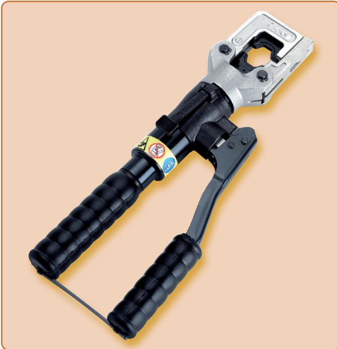
Die hydraulische Handpresse **HT51** ist für das Arbeiten auf engstem Raum hervorragend geeignet. Durch die neue Doppelkolbenhydraulik ist es auch bei kleinsten Querschnitten möglich, den Leerhub sehr schnell zu überbrücken. Der um 180° drehbare Kopf ermöglicht eine einfache Handhabung. Das integrierte Druckablasssystem kann zu jedem Zeitpunkt leicht betätigt werden. Es steht eine umfangreiche Palette von Presseinsätzen zur Verfügung (ab Seite 140).
