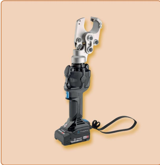
Das hydraulische Akkuschneidwerkzeug **B-TC320NDF** mit Doppelkolbenhydraulik, ist besonders geeignet zum Schneiden von Kupfer-, Aluminium und Telefonkabeln bis zu einem max. Durchmesser von 32 mm. Der offene Kopf, erleichtert das Arbeiten an schwer zugänglichen Orten. Das Handling ist durch den um 180° drehbaren Kopf sehr gut gewährleistet.
