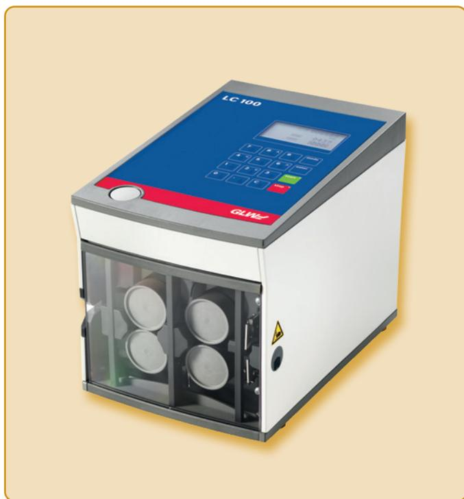
Das Ablängen von Kabeln mit dem **LC-100** bietet ein erhebliches Einsparpotenzial. Die Frontklappe wird einfach durch Tastendruck geöffnet. Nach dem Einlegen des Kabels werden beim Schliessen der Klappe die Mess- und Transportrollen automatisch auf den Durchmesser angepasst. Die gewünschte Länge und die Stückzahl auf dem Bedienpult eingeben und die Produktion kann beginnen.
