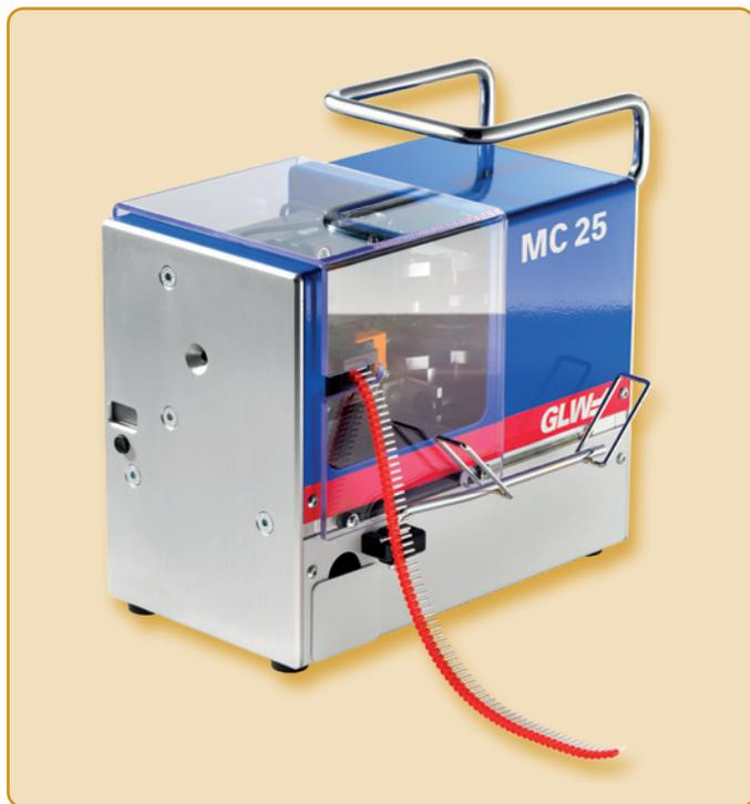
Der **MC25** verarbeitet Aderendhülsen in Bandform 0.25 – 2.5 mm<sup>2</sup> / Standardlänge 8 mm. Durch seine kompakte Bauweise lässt er sich auch bequem an wechselnden Arbeitsplätzen einsetzen. So wird er Ihr rationeller Helfer bei der Verarbeitung von isolierten Aderendhülsen.
