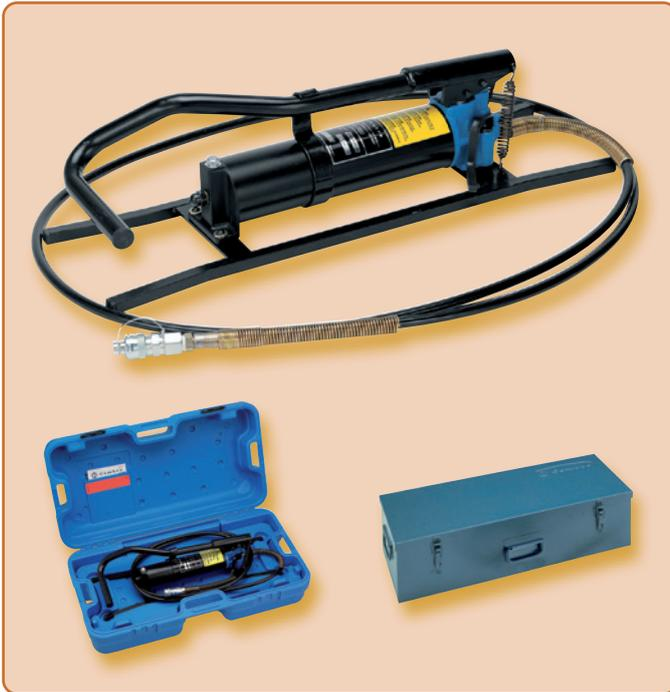
Hydraulische Doppelkolbenfusspumpe **PO7000** mit einem maximalen Betriebsdruck von 700 bar. Die Pumpe wird komplett mit einem 3 m Hochdruckschlauch und einer 3/8" NPT ölverlustfreien Schnellkupplung geliefert. Das Ablassen des Druckes erfolgt über ein leicht zu bedienendes Pedal, das auf der Rückseite der Pumpe angebracht ist.
