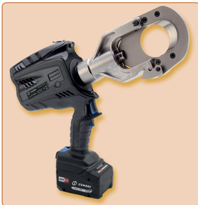
Das hydraulische Akkuschneidwerkzeug **B-TC650** mit Doppelkolbenhydraulik, ist zum Schneiden von Kupfer-, Aluminium und Telefonkabeln bis zu einem maximalen Durchmesser von 65 mm entwickelt worden. Durch den Klappverschluss des Kopfes kann das Werkzeug auch zum Schneiden von Endlosmaterial eingesetzt werden. Das gute Handling ist durch den um 335° drehbaren Kopf gewährleistet.
