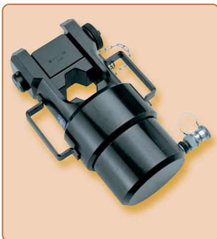
Der hydraulische Presskopf **RHU520** ist mit einer ölverlustfreien Schnellkuppelung ausgerüstet, die den Anschluss an eine Hydraulikpumpe mit einem maximalen Betriebsdruck von 700 bar ermöglicht (siehe hydraulische Pumpen, ab Seite 131). Mit dem Adapter (Typ **AU 520-130C**) können die Presseinsätze der 130-kN-Werkzeuge von Cembre ebenfalls mit dem **RHU520** benutzt werden.
