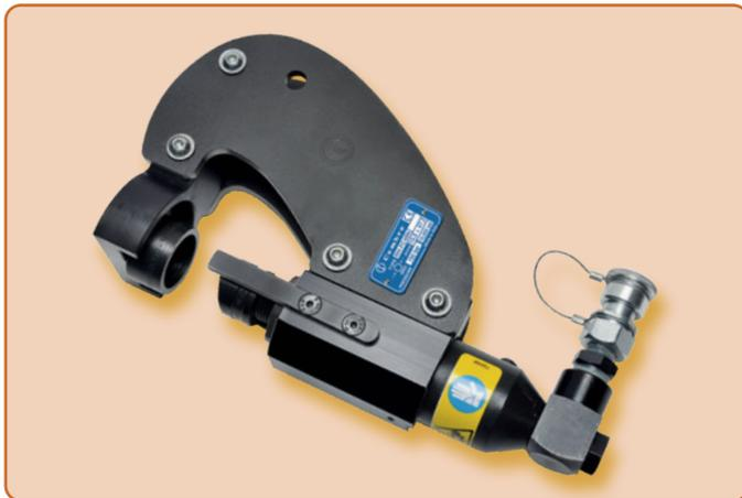
Hydraulischer Lochstanzkopf zum Stanzen von Löchern von 15.5 bis 47.2 mm Durchmesser ohne in die Seitenwände von Kabelkanälen bohren zu müssen. Das Werkzeug ist sehr leicht und ausbalanciert und lässt sich mit einer Hand bedienen.
