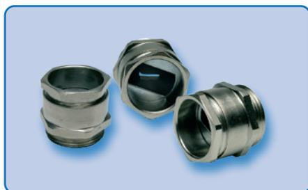
Dieses Verschraubungssystem ist für verschieden grosse Flachkabel universell einsetzbar. Alle gängigen Flachkabelabmessungen zwischen 4 x 1.5 mm<sup>2</sup> und 4 x 16 mm<sup>2</sup> können mit den fünf Grössen angeschlossen werden.
