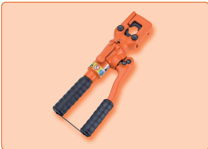
Die isolierte hydraulische Handpresse **HT51-KV** ist für das Arbeiten auf engstem Raum hervorragend geeignet. Durch die neue Doppelkolbenhydraulik ist es auch bei kleinsten Querschnitten möglich, den Leerhub sehr schnell zu überbrücken. Der um 180° drehbare Kopf ermöglicht eine einfache Handhabung.
