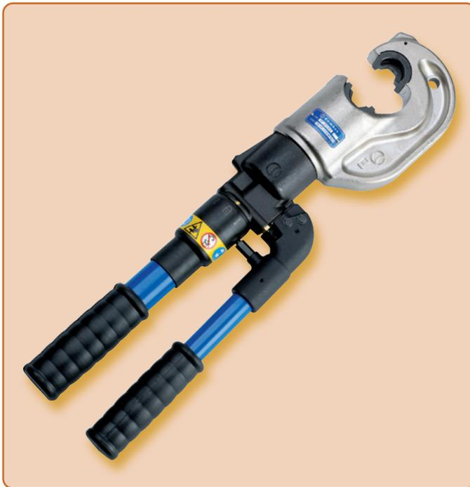
Die **HT131LN-C** ist eine hydraulische Handpresse mit Doppelkolbenhydraulik, die ein schnelles Arbeiten gewährleistet. Bei der **HT131LN-C** beträgt die Öffnungsweite des Kopfes 42 mm. Sie ist besonders zum Verpressen von grösseren Querschnitten geeignet. Der um 180° drehbare Kopf ermöglicht eine einfache Handhabung. Das integrierte Druckablasssystem kann zu jedem Zeitpunkt leicht betätigt werden. Es steht eine umfangreiche Palette von Presseinsätzen zur Verfügung (ab Seite 140).
