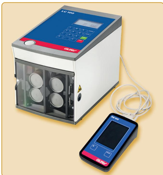
Für das abblängen von Litzen ist der **LC-100RB** mit einer externen Steuerung ausgestattet. Damit können Aufträge mit einem Zwischenstopp angehalten werden, um weitere Arbeitsschritte zu erledigen, wie das Anbringen von Markierern. Der Auftrag kann komplett pausiert werden, was bei grösseren Projekten hilfreich sein kann. Die Transportgeschwindigkeit kann einfach ans Projekt angepasst werden. Dazu kann die Schneidefunktion und der Nullschnitt deaktiviert werden.
