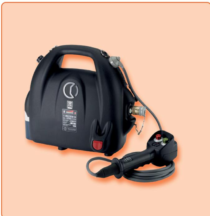
Die isolierte hydraulische Akkupumpe **B70M-P24-KV** ist mit isolierendem Hydrauliköl gefüllt und verfügt über einen 24 V – 3.1 Ah Akku und arbeitet mit einem Arbeitsdruck von 700 bar. Die Pumpe kann durch eine pneumatische Hand-Fernbedienung betätigt werden.
