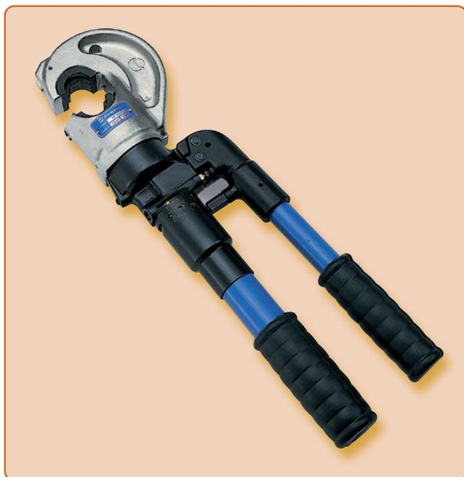
Die **HT131-C** ist eine hydraulische Handpresse mit Doppelkolbenhydraulik, die ein schnelles Arbeiten gewährleistet. Der um 180° drehbare Kopf ermöglicht eine einfache Handhabung. Das integrierte Druckablasssystem kann zu jedem Zeitpunkt leicht betätigt werden. Es steht eine umfangreiche Palette von Presseinsätzen zur Verfügung (ab Seite 140).
