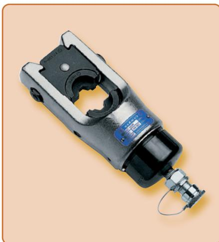
Der hydraulische Presskopf **RHU131-C** ist mit einer ölverlustfreien Schnellkupplung ausgerüstet, die den Anschluss an eine Hydraulikpumpe mit einem max. Betriebsdruck von 700 bar ermöglicht (siehe hydraulische Pumpen, ab Seite 131). Es steht eine umfangreiche Palette von Presseinsätzen zur Verfügung (ab Seite 140).
