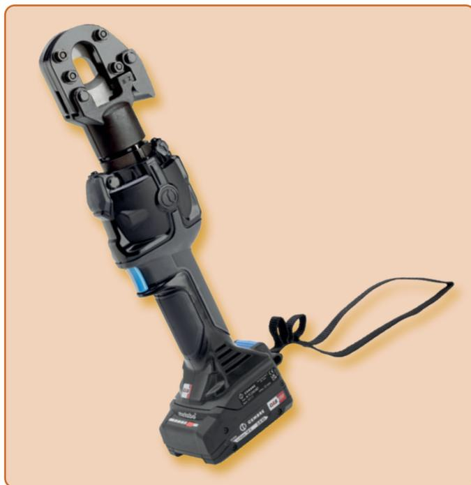
Der Stab-Akkuschneider **B-TC250ND** liegt ausgeglichen in der Hand. Das Werkzeug arbeitet sehr ruhig und vibrationsarm. Es ist geeignet zum Schneiden von massiven oder sehr harten Materialien bis zu einem maximalen Durchmesser von 25 mm (siehe Tabelle Seite 109). Die Schneidmesser sind deshalb aus besonders hochwertigem Material gefertigt. Der um 180° drehbare Kopf und der praktische Klappverschluss ermöglichen eine einfache Handhabung.
