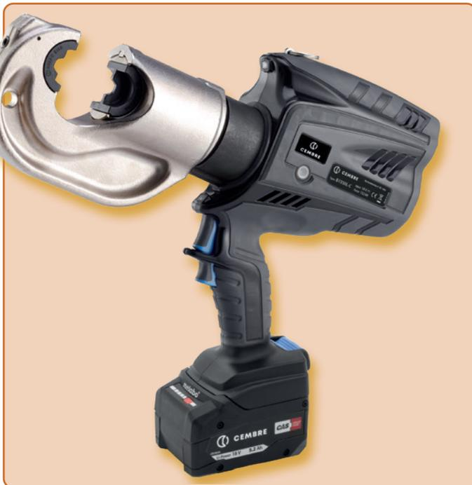
Die hydraulische Akkupresse **B1350L-C** verfügt über eine Doppelkolbenhydraulik. Der Presskopf ist um 180° drehbar, dadurch wird der Einsatz auf engstem Raum möglich. Die Öffnungsweite des Kopfes beträgt 42 mm und ist besonders zum Verpressen von grösseren Querschnitten geeignet. Passende Presseinsätze ab Seite 140.
