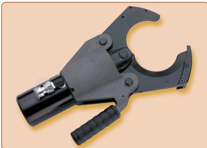
Der hydraulische Schneidkopf **TC096** ist zum Schneiden von Kabeln bis zu einem maximalen Durchmesser von 95 mm geeignet. Bei dieser offenen Schneidkopfausführung verhindert eine Messerführung ein Verkleben und Verkranten der zu schneidenden Materialien. Das Werkzeug ist mit einer ölverlustfreien Schnellkupplung ausgerüstet, die den Anschluss an eine Hydraulikpumpe mit einem maximalen Betriebsdruck von 700 bar ermöglicht (siehe hydraulische Pumpen, ab Seite 131).
