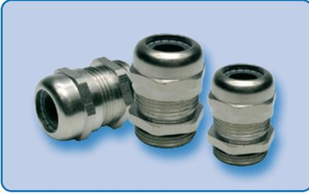
Material: vernickeltes Messing für Kabel mit Schirmung, mit innenliegender Zugentlastung nach EN 50262 Ausführung A, Lamellen-Einsatz aus PA6.6
