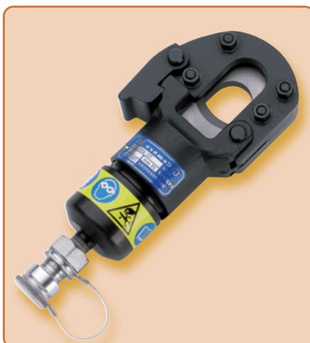
Der hydraulische Schneidkopf **TC025** ist geeignet zum Schneiden von massiven oder sehr harten Materialien bis zu einem maximalen Durchmesser von 25 mm. Die Schneidmesser sind deshalb aus besonders hochwertigem Material gefertigt. Das Werkzeug ist mit einer ölverlustfreien Schnellkupplung ausgerüstet, die den Anschluss an eine Hydraulikpumpe mit einem maximalen Betriebsdruck von 700 bar ermöglicht (siehe hydraulische Pumpen, ab Seite 131).
