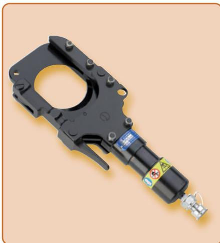
Der hydraulische Schneidkopf **TC085** ist zum Schneiden von Kabeln bis zu einem maximalen Durchmesser von 85 mm (z.B. 4 x 240 mm<sup>2</sup> NYY-0) geeignet. Durch den besonderen Schliff und die spezielle Geometrie der Schneidmesser wird ein «gerader Schnitt» garantiert. Das Werkzeug ist mit einer ölverlustfreien Schnellkupplung ausgerüstet, die den Anschluss an eine Hydraulikpumpe mit einem maximalen Betriebsdruck von 700 bar ermöglicht (siehe hydraulische Pumpen, ab Seite 131).
