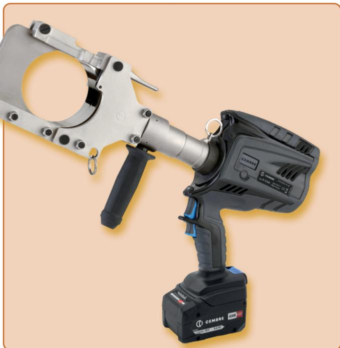
Das hydraulische Akkuschneidwerkzeug **B-TC950** mit Doppelkolbenhydraulik ist zum Schneiden von Kupfer-Aluminium-Kabeln bis zu einem maximalen Durchmesser von 95 mm entwickelt worden. Durch den Klappverschluss des Kopfes kann das Werkzeug auch zum Schneiden von Endlosmaterial eingesetzt werden. Das gute Handling ist durch den um 335° drehbaren Kopf optimal gewährleistet.
