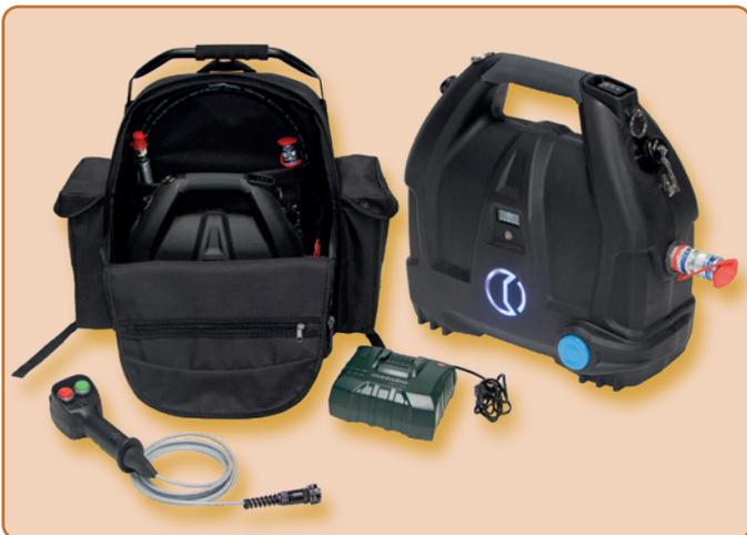
Die hydraulische Akkupumpe **B70M-P36** verfügt über einen 36V - 6.2 Ah Akku und arbeitet mit einem Arbeitsdruck von 700 bar. Die Pumpe kann durch eine Hand- oder Fusspedal-Fernbedienung betätigt werden. Mit einer Akkuladung können zum Beispiel bis zu 90 Schnitte NAE-KEBY 3 x 150 mm<sup>2</sup> ausgeführt werden.
