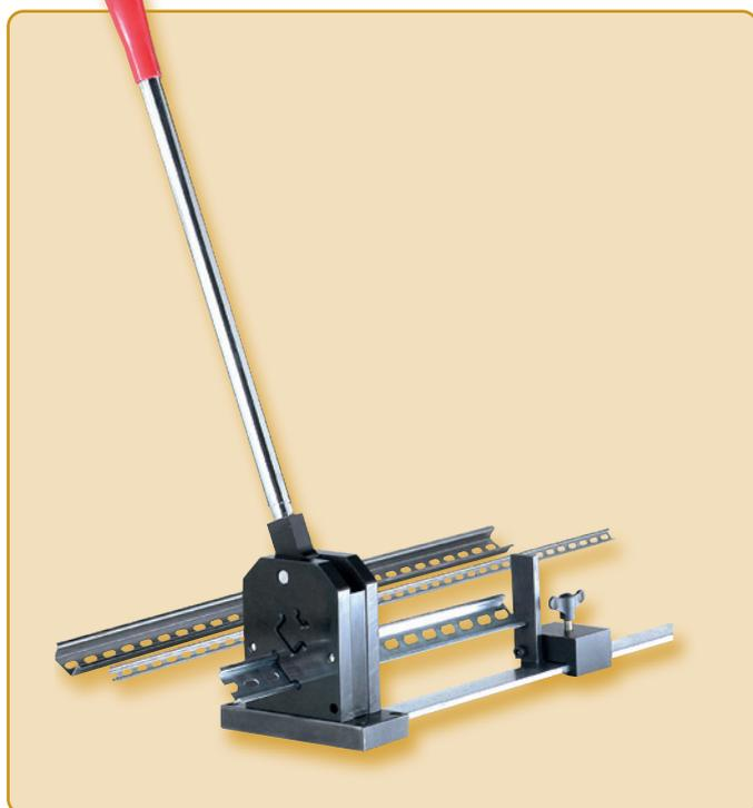
Zum schnellen und genauen Ablängen von Tragschienen DIN EN 60715. Der **RC-300** dient zum Ablängen von Tragschienen (Hutschienen) der Grössen TH 35-15, TH 35-7.5 und TH 15-5.5. Ohne grossen Kraftaufwand schneidet der **RC-300** schnell und gratfrei die gewünschten Längen. Mit der 1 m langen Massschiene werden die Tragschienen millimetergenau abgelängt. Die Schnittkanten sind winkelgenau und benötigen keine Nacharbeit. Der Arbeitsplatz bleibt sauber und spänefrei.
