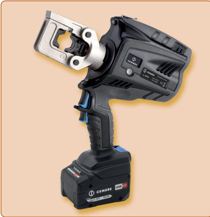
Die hydraulische Akkupresse **B500** verfügt über eine Doppelkolbenhydraulik. Der Presskopf ist um 180° drehbar, dadurch wird der Einsatz auf engstem Raum möglich. Es können alle Presseinsätze nach DIN 48083 verwendet werden, insbesondere die der 63 kN Werkzeuge. Passende Presseinsätze ab Seite 140.
