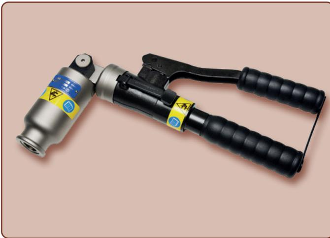
Hydraulisches Stanzwerkzeug zum Stanzen von Edelstahl, Stahl, Glasfaser und Kunststoff bis zu einer Materialstärke von max. 3.5 mm. Kompakt, leicht und einfach zu handhaben. Der Stanzkopf ist um 360° dreh- und 180° schwenkbar.
