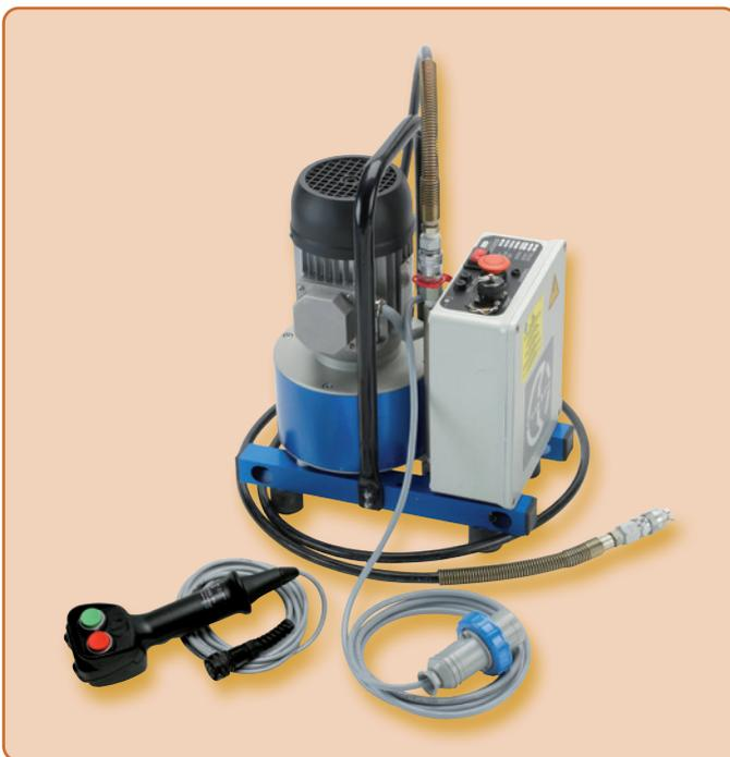
Die 220 V-Elektro-Hydraulikpumpe **CPE-1** arbeitet mit einem Einphasenmotor und einem maximalen Betriebsdruck von 700 bar. Die Steuerung der Pumpe erfolgt über die Handfernbedienung. An der Pumpe kann ebenfalls zu jedem Zeitpunkt der Druckabbau durch das Betätigen eines Tasters erfolgen. Es ist auch eine Ausführung für 110 V verfügbar. Beide Ausführungen haben die Schutzart IP55.
