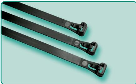
Die Eigenschaften entsprechen den Kabelbindern der G-Serie. Die Montage ist einfach und ohne Werkzeug möglich. Durch das Drücken der Zunge können die Kabelbinder wieder geöffnet werden und sind damit ideal für kurzfristige Bündelungen.
