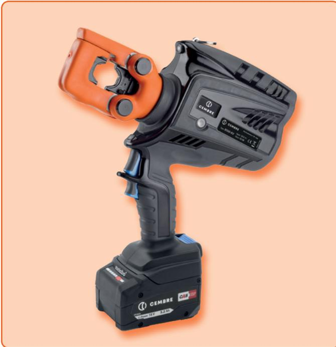
Die isolierte hydraulische Akkupresse **B500-KV** verfügt über eine Doppelkolbenhydraulik. Der Presskopf ist um 180° drehbar, dadurch wird der Einsatz auf engstem Raum möglich. Es können alle Presseinsätze nach DIN 48083 verwendet werden, insbesondere die der 63 kN Werkzeuge. Passende Presseinsätze ab Seite 140.
