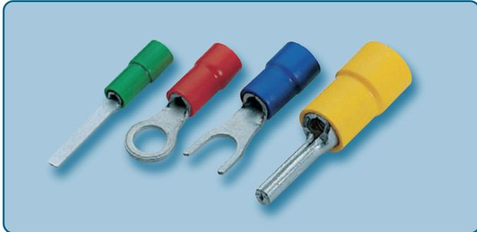
Typ «P» Kabelschuhe haben einen hohen Qualitätsstandard und entsprechen den Forderungen nach geringer Rauchgasentwicklung und geringer Toxizität für Mensch und Umwelt. Die Typ «P» Kabelschuhe sind mit halogenfreiem Kunststoff isoliert und haben dauerhafte thermische Eigenschaften: von -20 bis +115°C dauernd (kurzfristig bis 130°C). Der selbstverlöschende, halogenfreie Kunststoff erreicht nach UL94 die Bewertungsstufe V0. Passende Presswerkzeuge sind ab Seite 84 aufgeführt.
