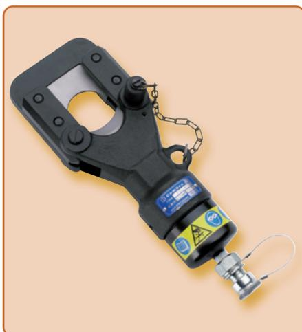
Der hydraulische Schneidkopf **TC04N** ist geeignet zum Schneiden von massiven oder sehr harten Materialien bis zu einem maximalen Durchmesser von 45 mm. Die Schneidmesser sind deshalb aus besonders hochwertigem Material gefertigt. Das Werkzeug ist mit einer ölverlustfreien Schnellkupplung ausgerüstet, die den Anschluss an eine Hydraulikpumpe mit einem maximalen Betriebsdruck von 700 bar ermöglicht (siehe hydraulische Pumpen, ab Seite 131).
