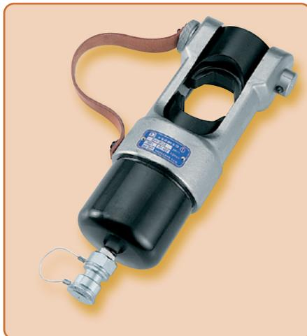
Der hydraulische Presskopf **ECW-H3D** ist mit einer ölverlustfreien Schnellkupplung ausgerüstet, die den Anschluss an eine Hydraulikpumpe mit einem maximalen Betriebsdruck von 700 bar ermöglicht (siehe hydraulische Pumpen, ab Seite 131). Die Presseinsätze entsprechen der Grösse 3 nach DIN 48083. Mit Hilfe des Adapters **AU230-130D** können auch alle Presseinsätze der 130-kN-Werkzeuge verwendet werden.
