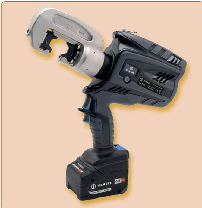
Die hydraulische Akkupresse **B600** verfügt über eine Doppelkolbenhydraulik. Der Presskopf ist um 180° drehbar, dadurch wird der Einsatz auf engstem Raum möglich. Es können alle Presseinsätze nach DIN 48083 verwendet werden, insbesondere die der 68 kN Werkzeuge (Öffnungsfeder erforderlich). Es können auch Zapfen Presseinsätze Größe 1 anderer Hersteller eingesetzt werden. Passende Presseinsätze ab Seite 140.
