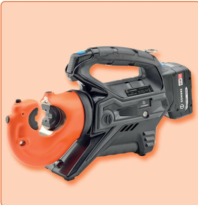
Die isolierte hydraulische Akkupresse **B1300-C-KV** verfügt über eine Doppelkolbenhydraulik. Der Presskopf ist um 180° drehbar, dadurch wird der Einsatz auf engstem Raum möglich. Ein Chip kontrolliert die Arbeitsweise und schaltet automatisch den Motor ab, sobald die Verpressung erfolgt ist. Das spart Energie und verlängert die Lebensdauer des Akkus.
