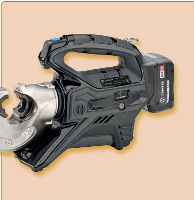
Die hydraulische Akkupresse **B1300-C** verfügt über eine Doppelkolbenhydraulik. Der Presskopf ist um 180° drehbar, dadurch wird der Einsatz auf engstem Raum möglich. Ein Chip kontrolliert die Arbeitsweise und schaltet automatisch den Motor ab, sobald die Verpressung erfolgt ist. Das spart Energie und verlängert die Lebensdauer des Akkus. Passende Presseinsätze ab Seite 140.
