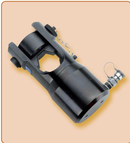
Der hydraulische Presskopf **RHU450** ist mit einer ölverlustfreien Schnellkuppelung ausgerüstet, die den Anschluss an eine Hydraulikpumpe mit einem maximalen Betriebsdruck von 700 bar ermöglicht (siehe hydraulische Pumpen, ab Seite 131). Mit dem Adapter (Typ **AU 450130 D**) können die Presseinsätze der 130-kN-Werkzeuge von Cembre ebenfalls mit dem **RHU450** benutzt werden.
