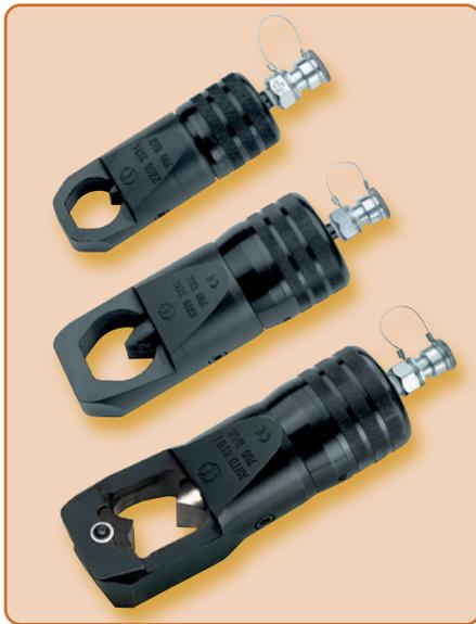
Diese Werkzeuge sind geeignet zum Lösen von Vierkant- und Sechskantmutter sowie Befestigungsbuchsen (siehe Tabelle). Zeitraubende und funkenentwickelnde Arbeiten wie Abschleifen oder Abtrennen entfallen. Die hydraulischen Mutternsprenger sind mit einer ölverlustfreien Schnellkupplung ausgerüstet, die den Anschluss an eine Hydraulikpumpe mit einem maximalen Betriebsdruck von 700 bar ermöglicht (siehe hydraulische Pumpen, ab Seite 131).
