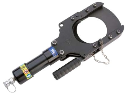
La testa di taglio oleodinamico TC120 serve per tagliare cavi con un diametro massimo fino a 120 mm. La pratica chiusura consente un utilizzo facilissimo. Grazie alla particolare affilatura e alla geometria speciale della lama di taglio è possibile garantire un taglio diritto. Il utensile è dotato di un raccordo ad attacco rapido senza fuoriuscite d'olio che consente il collegamento ad una pompa oleodinamica con una pressione di esercizio massima di 700 bar.
