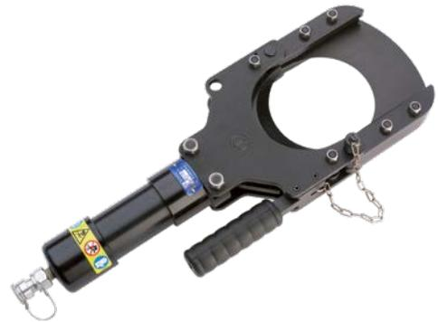
Der hydraulische Schneidkopf TC120 ist zum Schneiden von Kabeln bis zu einem maximalen Durchmesser von 120 mm geeignet. Der praktische Klappverschluss ermöglicht einfachste Handhabung. Durch den besonderen Schliff und die spezielle Geometrie der Schneidmesser wird ein «gerader Schnitt» garantiert. Das Werkzeug ist mit einer ölverlustfreien Schnellkupplung ausgerüstet, die den Anschluss an eine Hydraulikpumpe mit einem maximalen Betriebsdruck von 700 bar ermöglicht.
