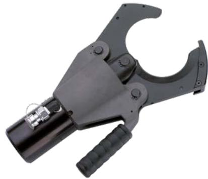
Der hydraulische Schneidkopf TC096 ist zum Schneiden von Kabeln bis zu einem maximalen Durchmesser von 95 mm geeignet. Bei dieser offenen Schneidkopfausführung verhindert eine Messerführung ein Verklemmen und Verkanten der zu schneidenden Materialien. Das Werkzeug ist mit einer ölverlustfreien Schnellkupplung ausgerüstet, die den Anschluss an eine Hydraulikpumpe mit einem maximalen Betriebsdruck von 700 bar ermöglicht.
