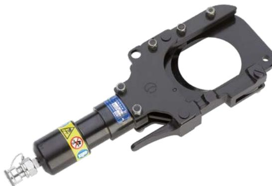
La testa di taglio oleodinamico TC085 serve per tagliare cavi con diametro massimo fino a 85 mm (ad es. 4 x 240 mm<sup>2</sup> NYY-0). Grazie alla particolare affilatura e alla geometria speciale della lama di taglio è possibile garantire un taglio dritto. Il utensile è dotato di un raccordo ad attacco rapido senza fuoriuscite d'olio che consente il collegamento ad una pompa oleodinamico con una pressione di esercizio massima di 700 bar.
