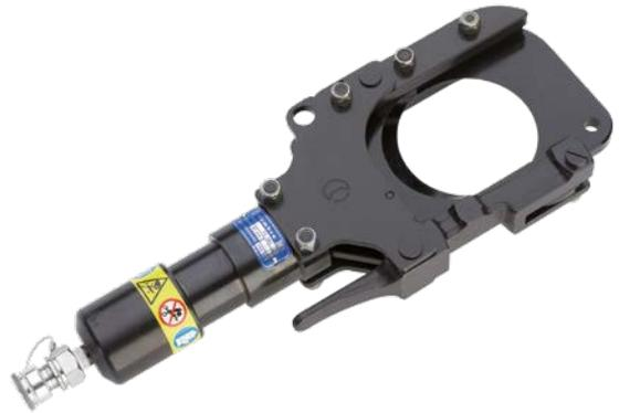
La tête de coupe hydraulique TC085 est conçue pour couper des câbles avec un diamètre maximal de 85 mm (par ex 4 x 240 mm<sup>2</sup> NYY-0). La coupe particulière et la forme spéciale des lames garantissent une « coupe droite ». L'outil est équipé d'un accouplement rapide sans perte d'huile, qui permet le raccordement à une pompe hydraulique avec une pression de service maximale de 700 bar.
