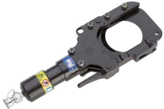
Der hydraulische Schneidkopf TC085 ist zum Schneiden von Kabeln bis zu einem maximalen Durchmesser von 85 mm (z B 4 x 240 mm<sup>2</sup> NYY-0) geeignet. Durch den besonderen Schliff und die spezielle Geometrie der Schneidmesser wird ein «gerader Schnitt» garantiert. Das Werkzeug ist mit einer ölverlustfreien Schnellkupplung ausgerüstet, die den Anschluss an eine Hydraulikpumpe mit einem maximalen Betriebsdruck von 700 bar ermöglicht.
