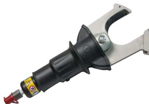
La tête de coupe hydraulique TC065-SC est conçue pour couper des câbles en cuivre, en aluminium et de téléphone avec un diamètre maximal de 65 mm. Les lames sont en acier de très haute qualité et résistantes à la chaleur afin de garantir une longue durée de vie. L'outil est équipé d'un accouplement rapide sans perte d'huile, qui permet le raccordement à une pompe hydraulique avec une pression de service maximale de 700 bar.
