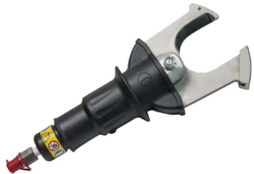
Der hydraulische Schneidkopf TC065-SC ist zum Schneiden von Kupfer-, Aluminium- und Telefonkabeln bis zu einem maximalen Durchmesser von 65 mm geeignet. Die Schneidmesser sind deshalb aus besonders hochwertigem Stahl gefertigt und wärme behandelt um eine lange Lebensdauer zu gewährleisten. Das Werkzeug ist mit einer ölverlustfreien Schnellkupplung ausgerüstet, die den Anschluss an eine Hydraulikpumpe mit einem maximalen Betriebsdruck von 700 bar ermöglicht.
