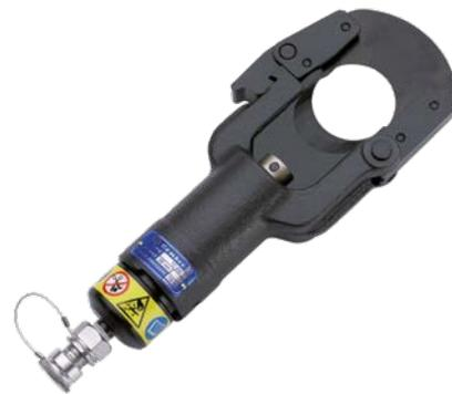
La testa di taglio oleodinamico TC050 serve per tagliare cavi con diametro massimo fino a 50 mm (ad es. 4 x 150 mm<sup>2</sup> NYY-0). Grazie alla particolare affilatura e alla geometria speciale della lama di taglio è possibile garantire un taglio diritto. Il utensile è dotato di un raccordo ad attacco rapido senza fuoriuscite d'olio che consente il collegamento ad una pompa oleodinamico con una pressione di esercizio massima di 700 bar.
