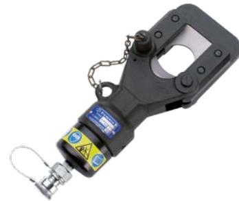
La tête de coupe hydraulique TC04N est conçue pour couper des câbles en matériaux massifs ou très durs avec un diamètre maximal de 45 mm. Les lames de coupe sont fabriquées dans un matériau de très haute qualité. L'outil est équipé d'un accouplement rapide sans perte d'huile, qui permet le raccordement à une pompe hydraulique avec une pression de service maximale de 700 bar.
