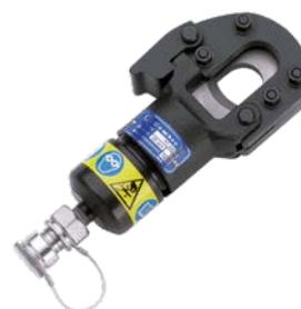
La testa di taglio oleodinamico TC025 serve per tagliare materiali grandi e molto duri con un diametro fino a 25 mm. Le lame di taglio sono rifinite in particolare metallo di alta qualità. Il utensile è dotato di un raccordo ad attacco rapido senza fuoriuscite d'olio che consente il collegamento ad una pompa oleodinamico con una pressione di esercizio massima di 700 bar.
