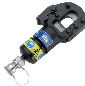
Der hydraulische Schneidkopf TC025 ist geeignet zum Schneiden von massiven oder sehr harten Materialien bis zu einem maximalen Durchmesser von 25 mm. Die Schneidmesser sind deshalb aus besonders hochwertigem Material gefertigt. Das Werkzeug ist mit einer ölverlustfreien Schnellkupplung ausgerüstet, die den Anschluss an eine Hydraulikpumpe mit einem maximalen Betriebsdruck von 700 bar ermöglicht.
