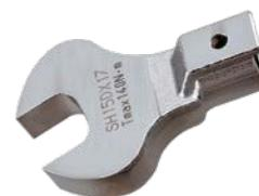
Les têtes de clé SH conviennent à l'endroit où les douilles ne peuvent pas être utilisées, pour des écrous évasés dans la tuyauterie et pour travailler dans des endroits étroits.
