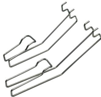
Le Clip sono utilizzabili per il fissaggio sicuro e durevole di cavi alla suola della rotaia fino a un diametro di 22 mm.
