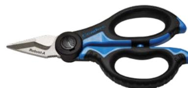
Forbici di qualità con lame in acciaio resistente e duraturo. I bulloni con protezione e dentatura sulle lame consentono un allineamento perfetto e regolare delle lame per lavori di taglio e isolamento eccellenti. In base al grado di durezza della lama (58 HRC) e allo spazio speciale, i cavi possono essere tagliati fino a 50 mm<sup>2</sup>. La lama è fornita in una protezione girevole (con custodia).
