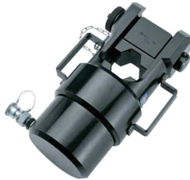
La testa di pressatura oleodinamico RHU520 è dotata di un raccordo ad attacco rapido senza fuoriuscite d'olio che consente il collegamento ad una pompa oleodinamico con una pressione di esercizio massima di 700 bar. Con l'adattatore (tipo AU 520-130C) è possibile utilizzare le teste di pressatura dell' utensile 130 kN di Cembre anche con il RHU520.
