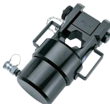
La tête de presse hydraulique RHU520 est équipée d'un accouplement rapide sans perte d'huile, qui permet le raccordement à une pompe hydraulique avec une pression de service maximale de 700 bar. Avec l'adaptateur (type AU 520-130C), toutes les matrices des outils de 130 kN de Cembre peuvent également être utilisées avec le RHU520.
