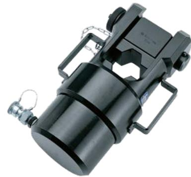
Der hydraulische Presskopf RHU520 ist mit einer ölverlustfreien Schnellkupplung ausgerüstet, die den Anschluss an eine Hydraulikpumpe mit einem maximalen Betriebsdruck von 700 bar ermöglicht. Mit dem Adapter (Typ AU 520-130C) können die Presseinsätze der 130-kN-Werkzeuge von Cembre ebenfalls mit dem RHU520 benutzt werden.
