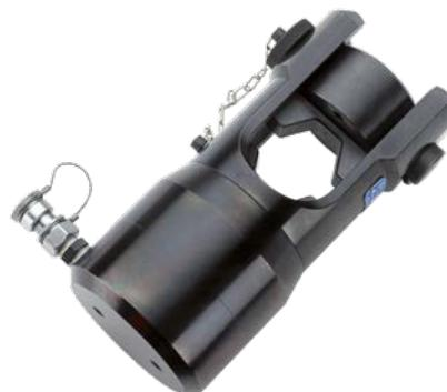
La testa di pressatura oleodinamico RHU450 è dotata di un raccordo ad attacco rapido senza fuoriuscite d'olio che consente il collegamento ad una pompa oleodinamico con una pressione di esercizio massima di 700 bar. Con l'adattatore (tipo AU 450130 D) è possibile utilizzare le teste di pressatura dell' utensile 130 kN di Cembre anche con il RHU 450.
