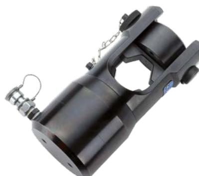
La tête de presse hydraulique RHU450 est équipée d'un accouplement rapide sans perte d'huile, qui permet le raccordement à une pompe hydraulique avec une pression de service maximale de 700 bar. Avec l'adaptateur (type AU 450130 D), toutes les matrices des outils de 130 kN de Cembre peuvent également être utilisées avec le RHU450.
