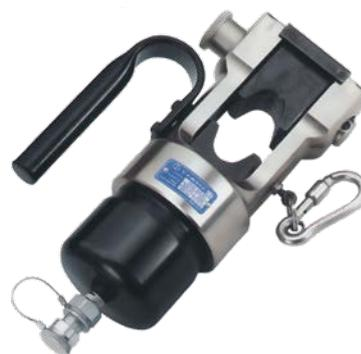
La tête de presse hydraulique RHU300-3D est appropriée pour la compression de caténaires, de cosses et de connecteurs de 10 à 630 mm<sup>2</sup>. L'outil est équipé d'un accouplement rapide sans perte d'huile, qui permet le raccordement à une pompe hydraulique avec une pression de service maximale de 850 bar. Des matrices de la taille 3 selon DIN 48083 partie 3 peuvent être utilisées.
