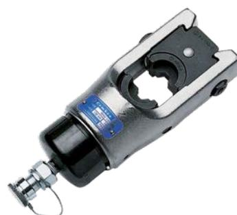
La testa di pressatura idraulica RHU131-C è dotata di un raccordo ad attacco rapido senza fuoriuscite d'olio che consente il collegamento ad una pompa idraulica con una pressione di esercizio massima di 700 bar.
