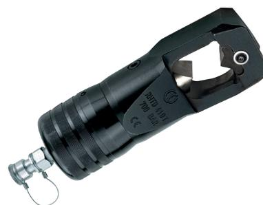
Questo utensile serve per svitare dadi a testa quadrata e esagonali e spine di fissaggio (vedere tabella). Lavori lunghi e durante i quali si sviluppano scintille come molatura o tagli. Gli apri-dadi idraulici sono dotati di un raccordo ad attacco rapido senza fuoriuscite d'olio che consente il collegamento ad una pompa oleodinamica con una pressione di esercizio massima di 700 bar.
