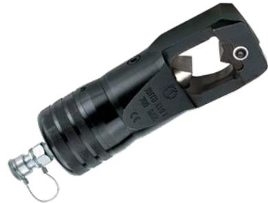
Dieses Werkzeug ist geeignet zum Lösen von Vierkant- und Sechskantmutter sowie Befestigungsbuchsen (siehe Tabelle). Zeitraubende und funkenentwickelnde Arbeiten wie Abschleifen oder Abtrennen entfallen. Die hydraulischen Mutternsprenger sind mit einer ölverlustfreien Schnellkupplung ausgerüstet, die den Anschluss an eine Hydraulikpumpe mit einem maximalen Betriebsdruck von 700 bar ermöglicht.
