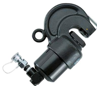
La tête de perçage hydraulique RHT160 permet de percer de manière rapide et précise des matériaux comme le cuivre, l'aluminium ou l'acier avec une épaisseur de paroi jusqu'à 10 mm. Les têtes de perçage hydrauliques sont équipées d'un accouplement rapide sans perte d'huile, qui permet le raccordement à une pompe hydraulique avec une pression de service maximale de 700 bar.
