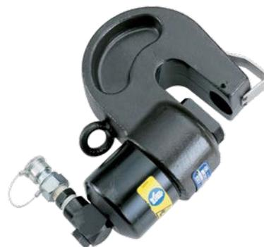
La tête de perçage hydraulique RHT160-60N permet de percer de manière rapide et précise des matériaux comme le cuivre, l'aluminium ou l'acier avec une épaisseur de paroi jusqu'à 10 mm. Les têtes de perçage hydrauliques sont équipées d'un accouplement rapide sans perte d'huile, qui permet le raccordement à une pompe hydraulique avec une pression de service maximale de 700 bar.
