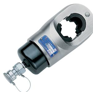
La testa di pressatura idraulica RHM132 è dotata di un raccordo ad attacco rapido senza fuoriuscite d'olio che consente il collegamento ad una pompa idraulica con una pressione di esercizio massima di 700 bar.
