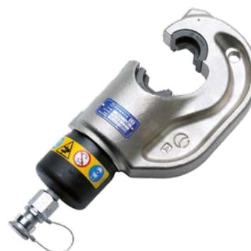
La testa di pressatura idraulica RHC131LN è dotata di un raccordo ad attacco rapido senza fuoriuscite d'olio che consente il collegamento ad una pompa idraulica con una pressione di esercizio massima di 700 bar. L'RHC131LN presenta un'ampiezza di apertura della testa di 42 mm. È particolarmente adatta a pressare tagli trasversali più grandi.
