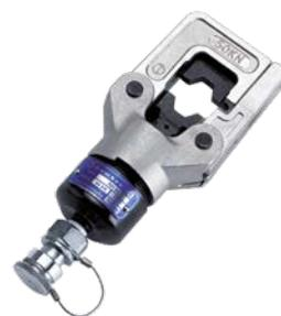
La testa di pressatura idraulica RH50 è dotata di un raccordo ad attacco rapido senza fuoriuscite d'olio che consente il collegamento ad una pompa idraulica con una pressione di esercizio massima di 700 bar.
