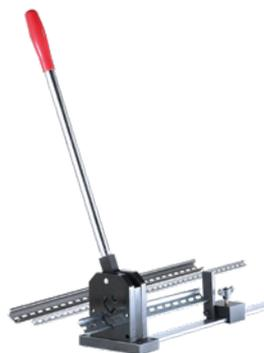
Pour la coupe rapide et précise de rails supports DIN EN 60715. Le RC-300 sert à couper des rails supports (rails chapeaux) des dimensions TH 35-15, TH 35-7,5 et TH 15-5,5. Le RC-300 coupe rapidement et sans bavures aux longueurs souhaitées, sans effort important. À l'aide du rail de mesure de 1 m, les rails supports sont coupés au millimètre près. Les arêtes sont coupées avec un angle précis et ne nécessitent pas de finitions. Le poste de travail reste propre et exempt de copeaux.
