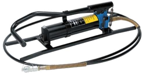
Hydraulische Doppelkolbenfusspumpe P07000 mit einem maximalen Betriebsdruck von 700 bar. Die Pumpe wird komplett mit einem 3 m Hochdruckschlauch und einer 3/8" NPT ölverlustfreien Schnellkupplung geliefert. Das Ablassen des Druckes erfolgt über ein leicht zu bedienendes Pedal, das auf der Rückseite der Pumpe angebracht ist.
