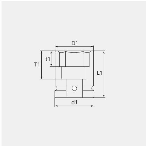
**DIMENSIONS****CS1:** 36**L1 (mm):** 56**D1 (Ø):** 50**d1 (Ø):** 40**T1 (mm):** 35**t1 (mm):** 20**REMARQUE**
