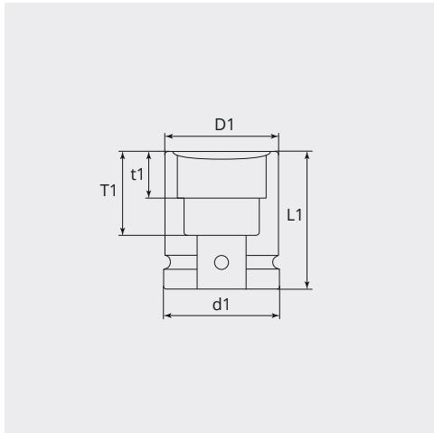
**DIMENSIONS****CS1:** 34**L1 (mm):** 70**D1 (Ø):** 61**d1 (Ø):** 44**T1 (mm):** 41**t1 (mm):** 30**REMARQUE**
