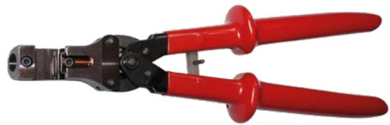
Die isolierte mechanische Handzange ME5-KV ermöglicht unisolierte Parallel-Verbinder und Kabelschuhe unter Spannung nach DIN-Norm zu Verpressen. Bei Erreichen der Presskraft verriegelt die Zange, was bedeutet, dass die Pressung korrekt abgeschlossen ist. Für eine nächste Pressung muss die Zange entriegelt werden. Matrizen auf Anfrage.
