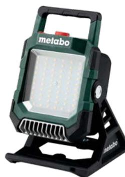
Il faretto da costruzione compatto a batteria ME-601505850 con 4000 lumen fornisce una luce di lavoro ampia e uniforme con ombre ridotte. La testa della lampada può essere ruotata orizzontalmente di 270° per posizioni di illuminazione quasi illimitate. La funzione di dimmerazione infinitamente variabile fornisce una luce ottimale con la massima durata della batteria. È a prova di polvere e spruzzi per un uso esigente in cantiere (IP 54).
