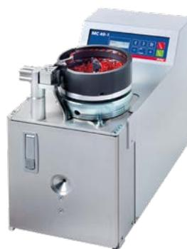
Le appareile à dénuder et à sertir électropneumatiques MC-40-1 servent à traiter de manière rationnelle les embouts en vracs avec une collerette en plastique. Le dénudage et le sertissage sont effectués en une seule opération. Le MC-40-1 est équipé en série d'outils de sertissage de section 0,5 / 0,75 / 1,0 / 1,5 mm<sup>2</sup> avec une longueur de douilles de 6-12 mm. Pour le traitement des sections 0,25 / 0,34 / 2,5 et 4 mm<sup>2</sup>, il existe des kits d'extension correspondants.
